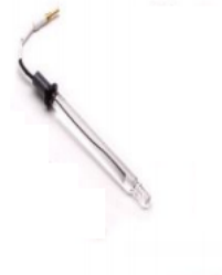
Şekil 3.3. Deneyde kullanılan BAS marka Ag/AgCl referans elektrotu
