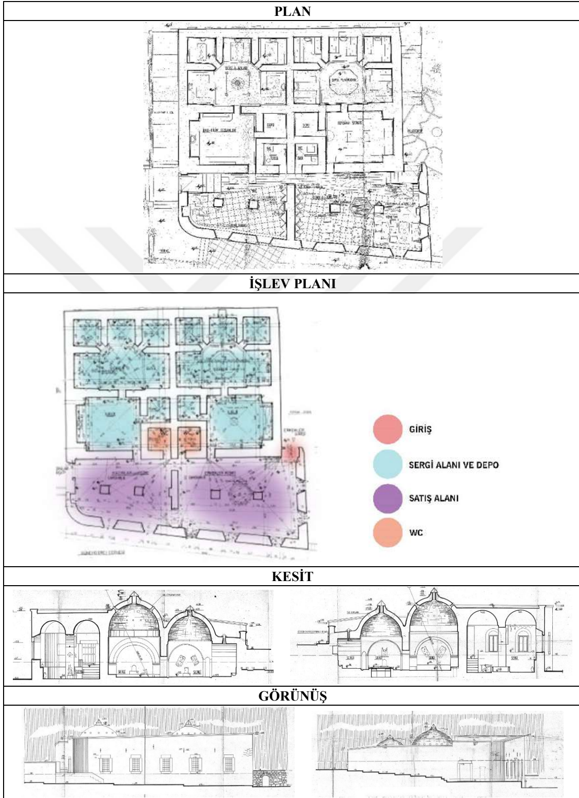
Çizelge 3.10. Ak Hamam plan, kesit ve görünüş (KBB – KUDEB'den alınan çizimlerden elde edilmiştir)
