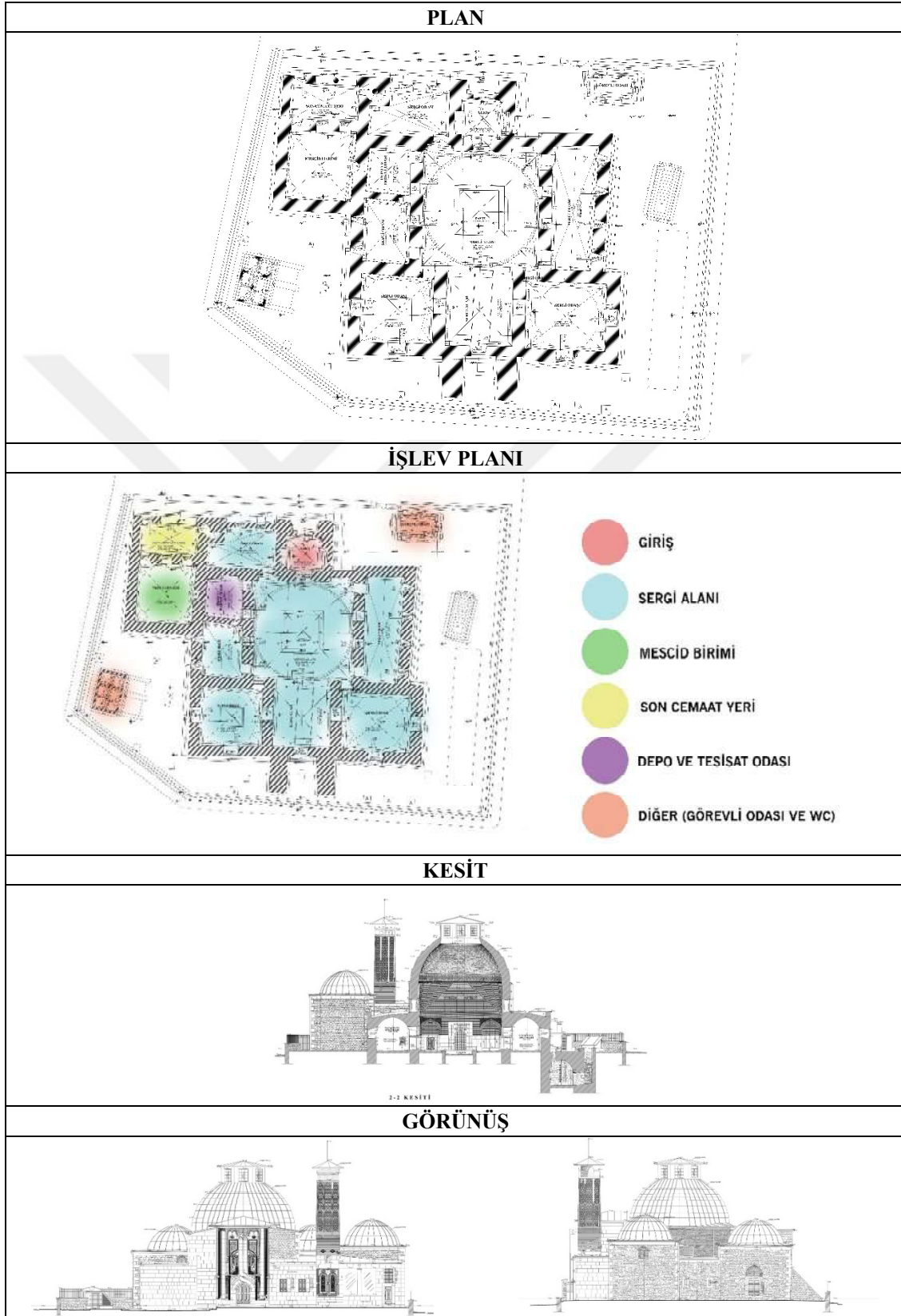
Çizelge 3.2. İnce Minare Medresesi plan, kesit ve görünüş (VBM'den alınan çizimlerden elde edilmiştir)
