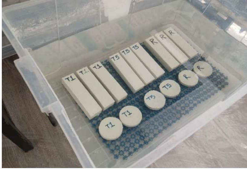
Şekil 3.13. Numunelerin su havuzunda bekletilmesi
