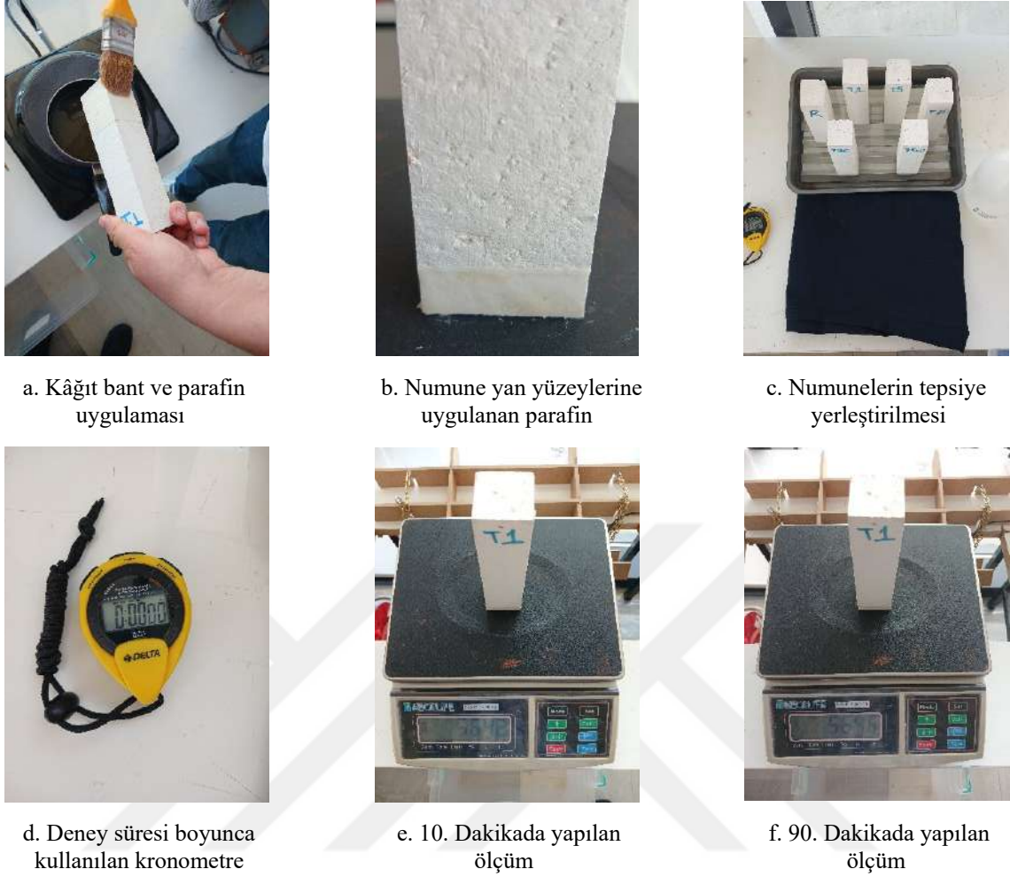
Şekil 3.16. Kılcallık deneyinin uygulanması
