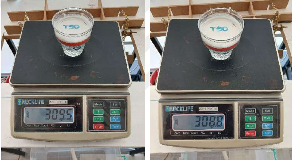
Şekil 3.19. T50 numunesinin 24 saat aralıklarla tartılması
