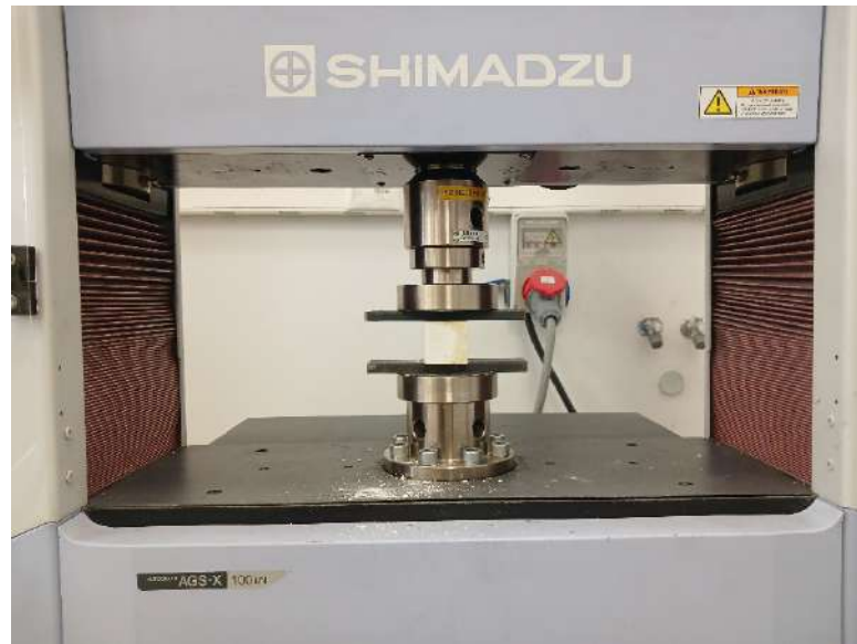
Şekil 3.22. Basınç dayanımı deneyinin uygulanması
