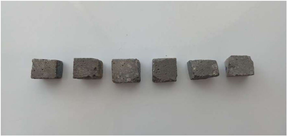
Şekil 3.24. Yüzeyleri altın/paladyum ile kaplanan numune örnekleri
