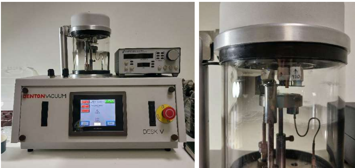
Şekil 3.25. Altın/paladyum kaplamasının yapıldığı cihaz
