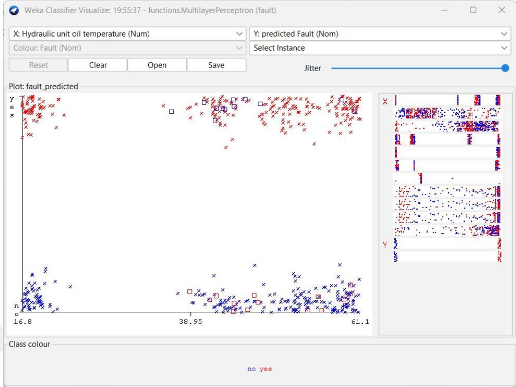
Şekil 4.2. Hidrolik ünite yağ sıcaklığı-arıza tahmini ilişkisi
