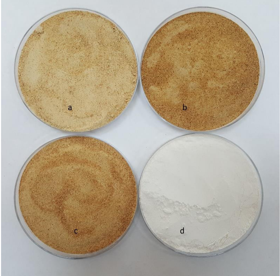
(a) Konveksiyonel kurutma yöntemi ile kurutulmuş hünnap meyve tozu, (b) mikrodalga kurutma yöntemi ile kurutulmuş hünnap meyve tozu, (c) vakum kurutma yöntemi ile kurutulmuş hünnap meyve tozu, (d) buğday unu
