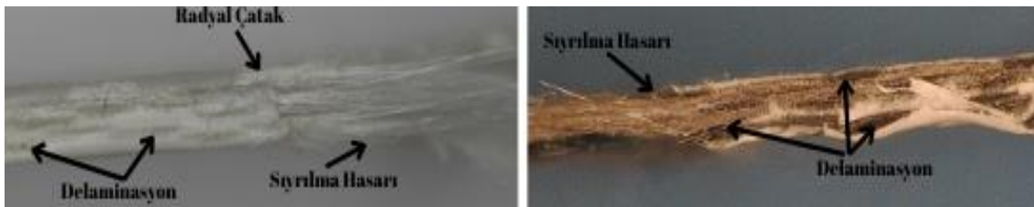
Şekil 4. 23. Çekme testi hasarlı numune optik mikroskop görüntüleri
