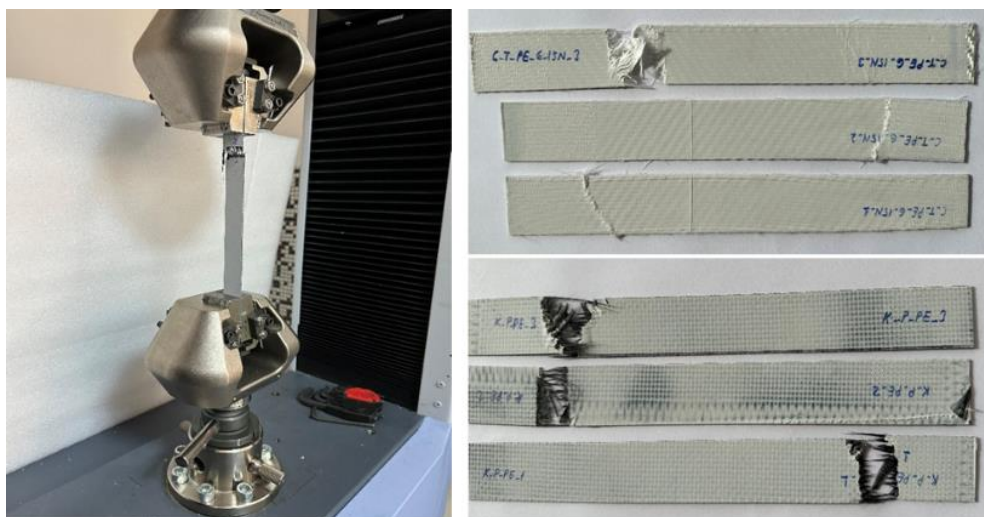
Şekil 4. 21. Çekme testi esnasında ve sonrasında hasarlı numune gösterimi
