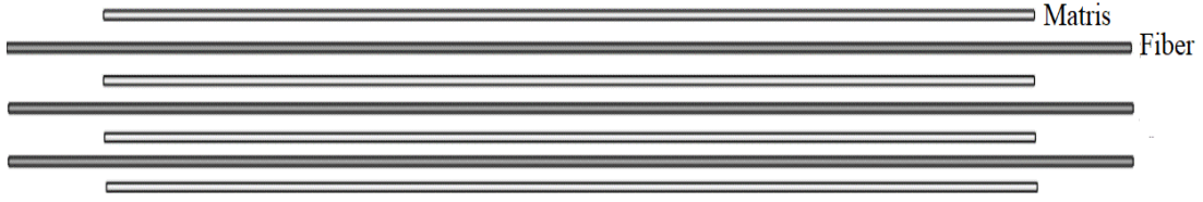
Şekil 3. 2. Cam ve karbon fiber takviyeli PE matrisli numune dizilimi
