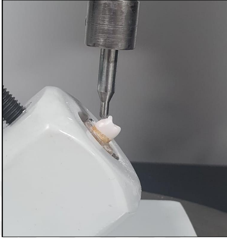
Şekil 3.21. Akrilik blokların 45° açıyla kırma cihazına yerleştirilmesi
