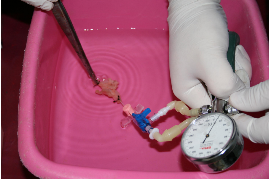
Şekil 8 : Anastomozdan gaz kabarcıkları çıktığı andaki manometre değeri patlama basıncı değeri olarak kaydedildi.
