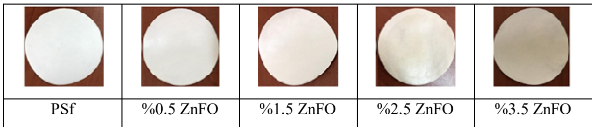
Şekil 3.2. Farklı ZnFO bileşimiyle hazırlanan membranlar
