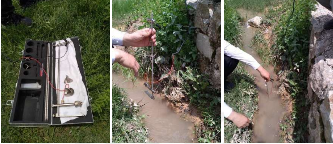
Resim 4.2. a) Muline Cihazı, b) Muline Cihazı ile Debi Ölçümü
