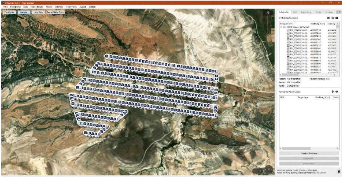
Şekil 5.14. 3D Survey Programında Drone Fotoğraflarının Birleştirilmesi
