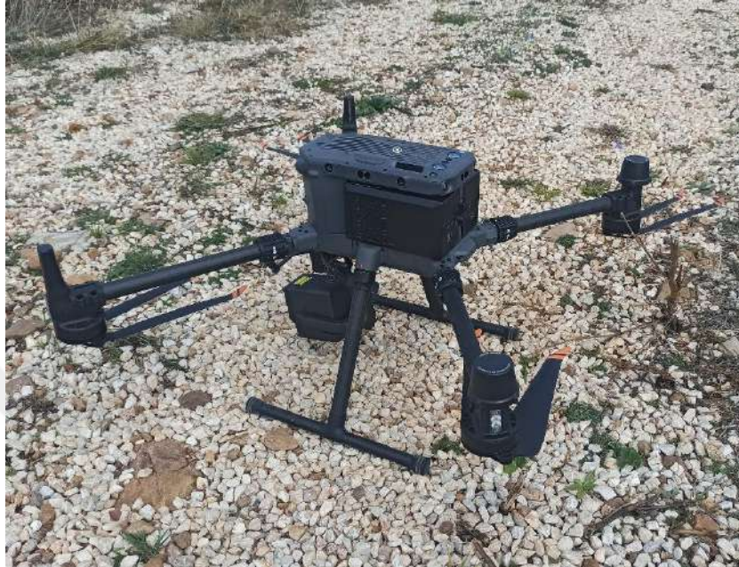
Resim 4.6. DJI Enterprise Matrice 350 RTK Marka Dron ve DJI Zenmuse L1 LIDAR Cihazı
