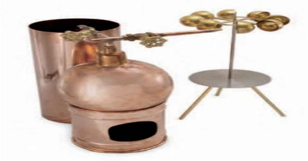
Şekil 1.5. Takıyüddin Er-Râsîd'in dikey buharlı döner kebab ocağı tasarımı (Sezgin, 2008, s. 37).
