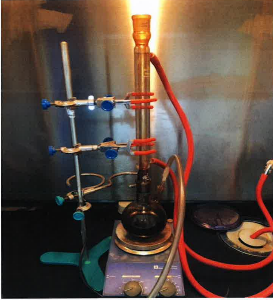
Şekil 3.2. Fe 3 O 4 /TiO 2 sentezi için kullanılan deney düzeneği
