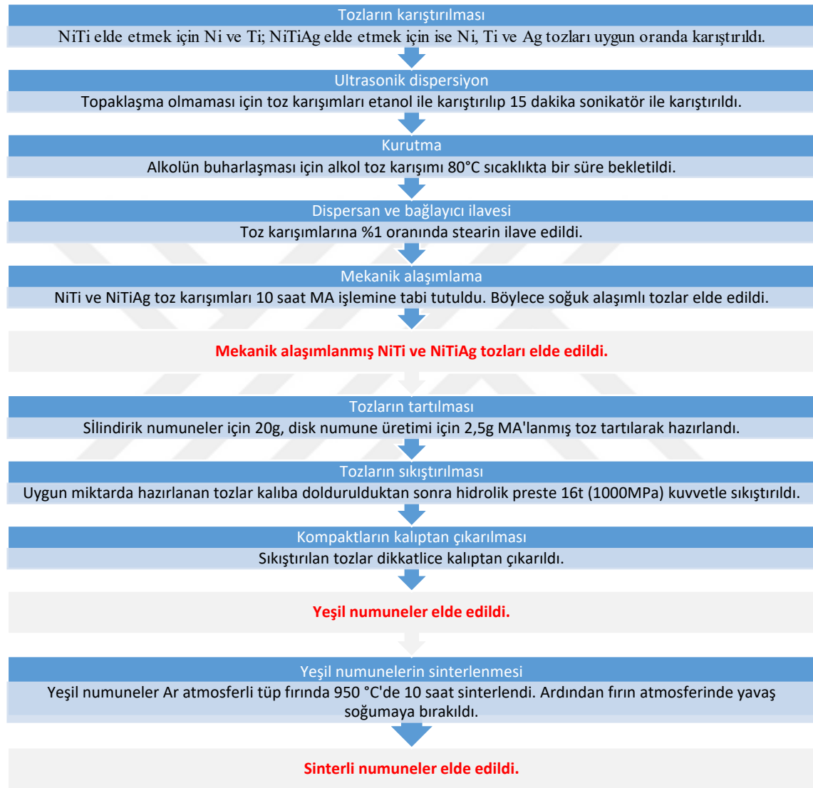
Şekil 3.1. Toz numunelerden sinterli disk ve silindir üretimi aşamaları
