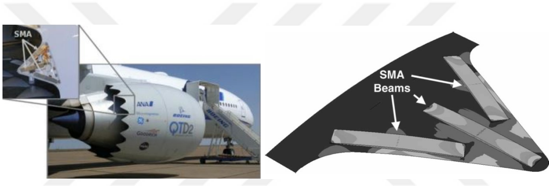
Şekil 2.3. Boeing denemeler yaptığı sıcaklık tetiklemeli SME şevronlar (Calkins vd., 2006)
