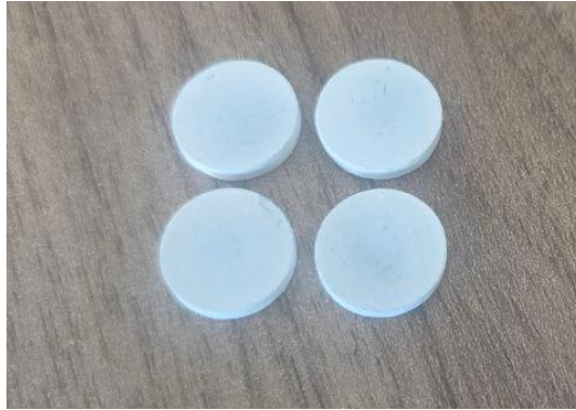
Şekil 3.23. Elektrospın ile PCL+HA kaplanmış disk numuneler
