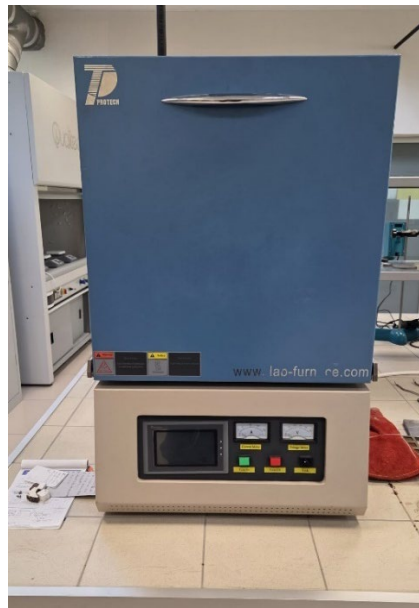
Şekil 3.19. Silanın kürlendiği Protech, PP-M1700-8L-IC, 5 kW mufla fırın
