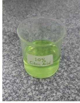
Şekil 3.18. Sitrik asit pasivasyonu sonucu oluşan nikel tuzu nedeniyle renksiz solüsyon renginin yeşile dönmesi
