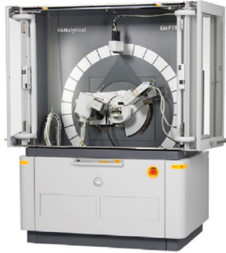
Şekil 3.4. EMPYREAN Panalytical difraktometresi
