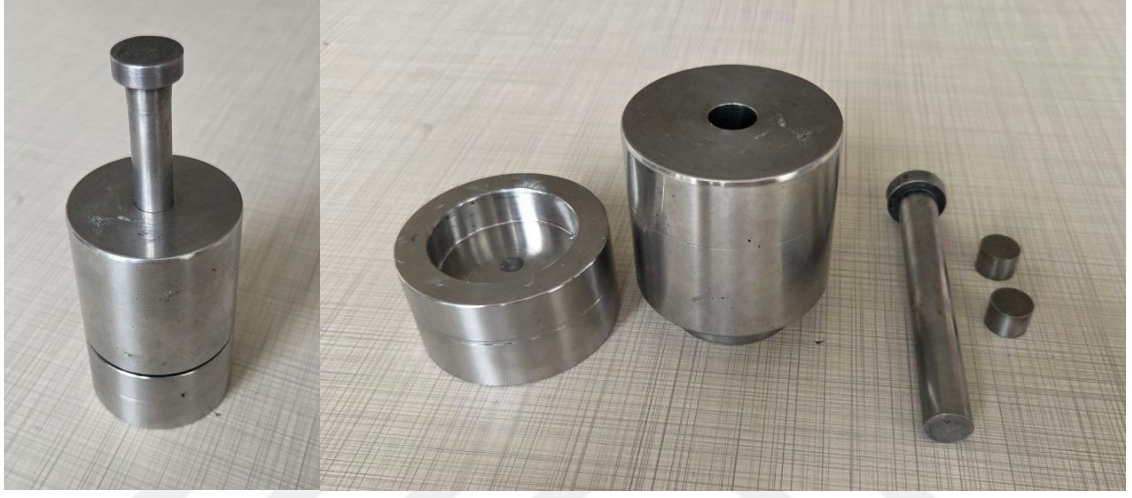
Şekil 3.7 Tozların sıkıştırıldığı tek eksenli kalıbın birleştirilmiş ve ayrılmış resmi
