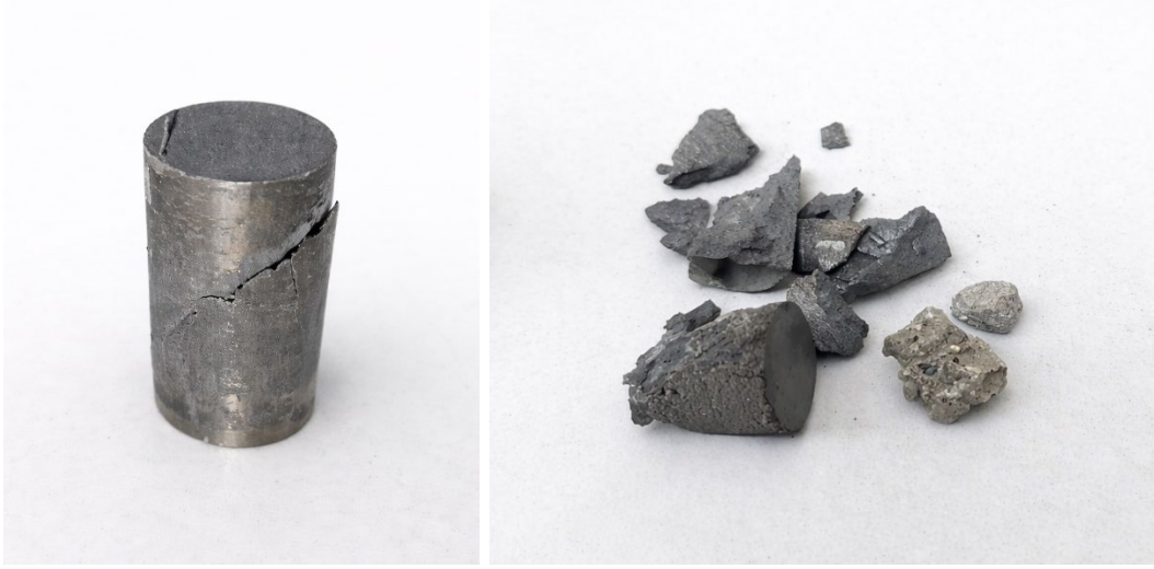
Şekil 4.11. NiTiAg numunelerde kırılma sonrası çatlak ilerlemesi ve parçalanma durumu
