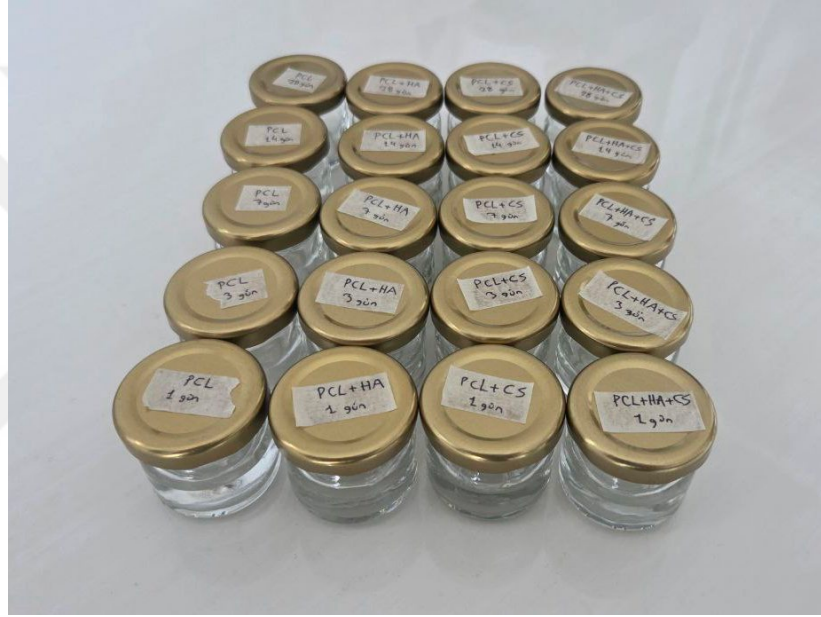
Şekil 3.27. Her bir kaplama türü için biyobozunurluk testi sonrası elde edilen ve iyon salım testi için HNO 3 eklenip bozdolabında muhafaza edilen ekstraktlar
