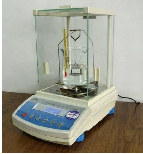
Şekil 3.10. RADWAG hassas terazi ve yoğunluk ölçme kiti
