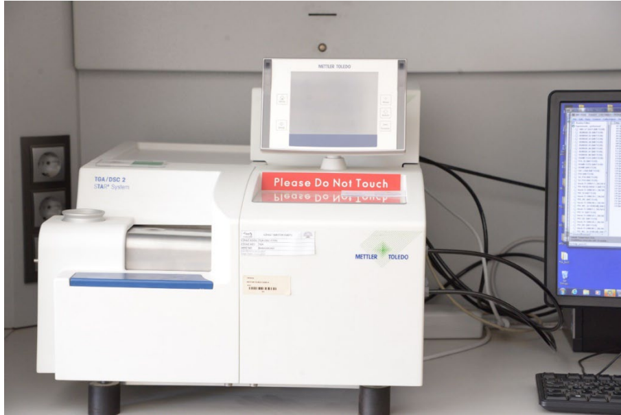
Şekil 3.15. METTLER TOLEDO DSC1 ölçüm cihazı
