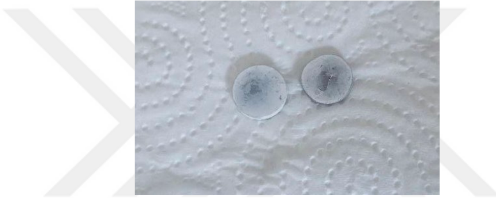
Şekil 3.26. Tartım sonrası kurutma fırınına konulmadan önce PCL+HA kaplı disk numuneler
