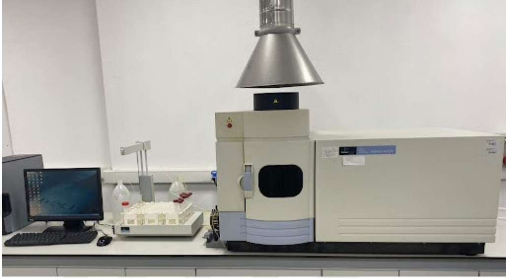
Şekil 3.28. Perkin Elmer marka Optima 2100 DV ICP-OES spektrometresi
