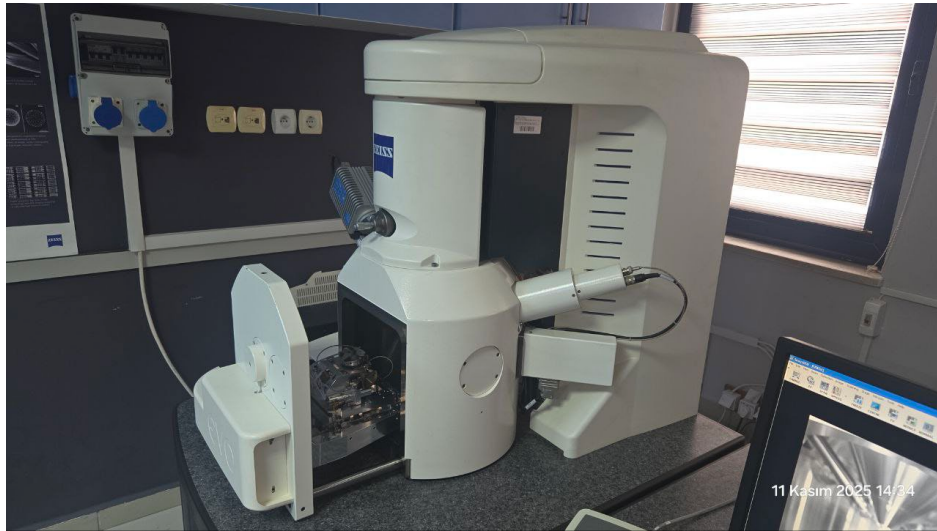
Şekil 3.14. ZEISS Evo-LS10 taramalı elektron mikroskobu
