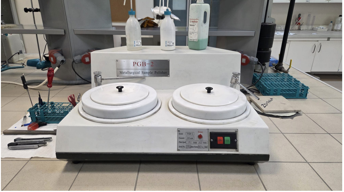
Şekil 3.17. Numunelerin zımparalanmasında kullanılan diskli parlatici
