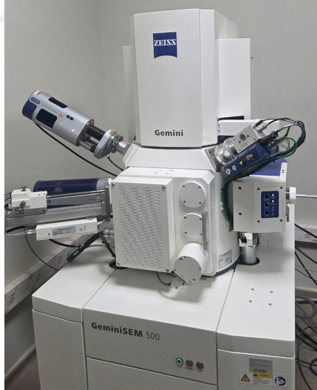
Şekil 3.5. Ham ve MA'lanmış tozların incelenmesinde kullanılan ZEISS GeminiSEM 500 FE-SEM cihazı
