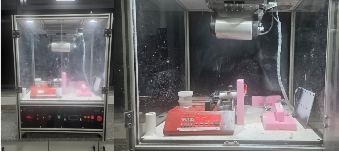
Şekil 3.22. Elektrospın cihazı ve numune kaplama düzeneği
