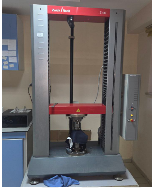
Şekil 3.13. Basma testinde kullanılan ZWICK/ROELL Z100 cihazı
