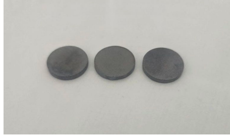
Şekil 3.20. Kaplanmaya hazır hale getirilmiş disk formundaki numuneler
