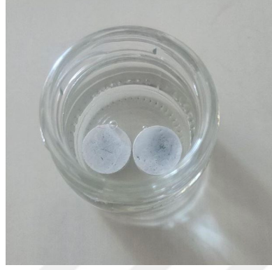
Şekil 3.25. Şişme testi için PBS'ye daldırılmış 2 adet PCL+HA kaplı numune
