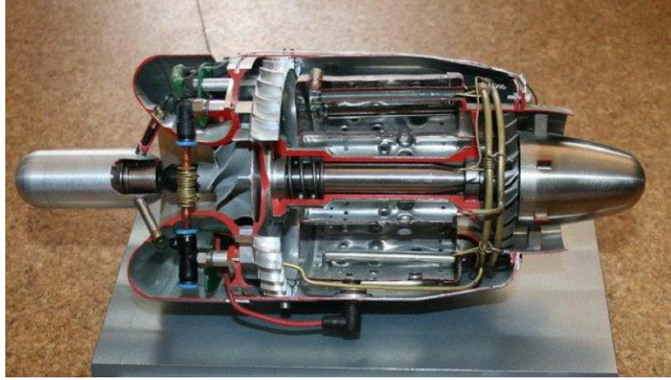
Şekil 6. Turbojet motoru jenerik kesiti (Baş, 2021)
