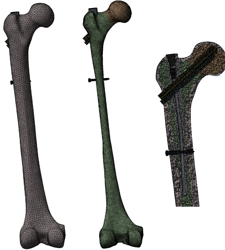
Şekil 4.19. Femur-PFN İmplant Sisteminin Sonlu Elemanlar Modeli
