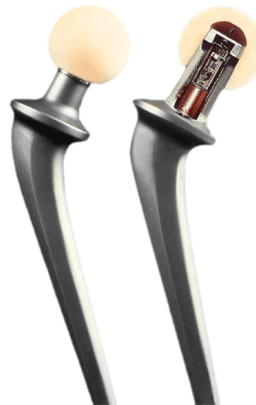
Şekil 4.8. Kalça Protez İçi Gerinim Ölçer ( www.othoload.com )
