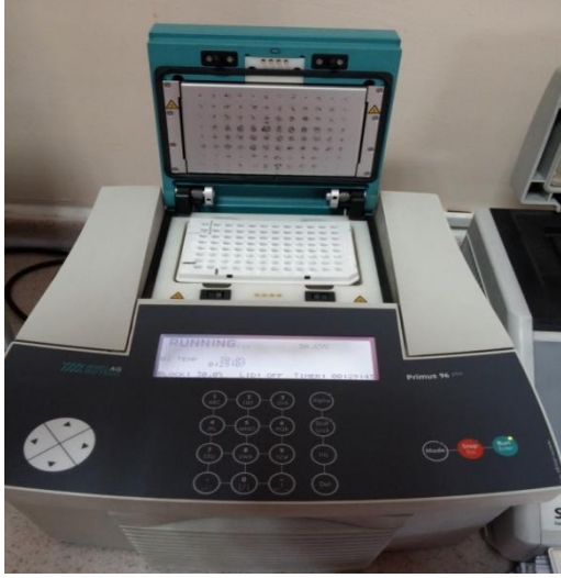
Şekil 3.3. Isı döngü cihazı (Primus 96 plus, MWG AG Biotech, Almanya)
