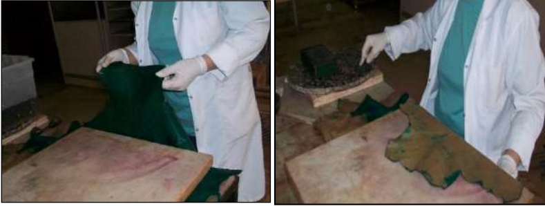
Fotoğraf 16: Mermer dışında bırakılan deri miktarı Fotoğraf 17: Derinin mermer üzerine serilmesi
