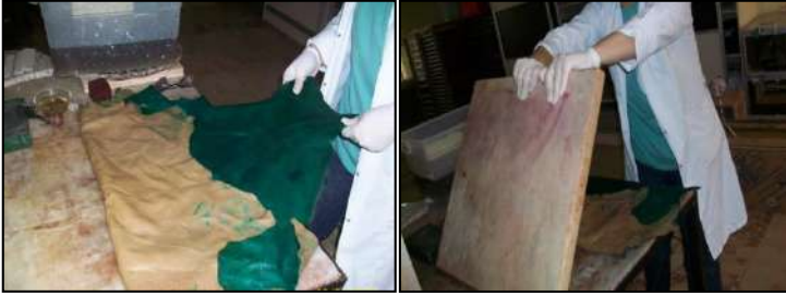
Fotoğraf 14: Derinin mermer masa üzerine serilmesi Fotoğraf 15: Deri üzerine mermerin yerleştirilmesi
