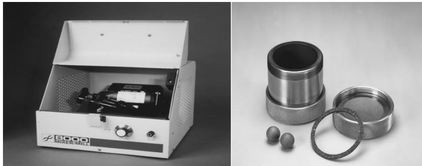
Şekil 2. 3. SPEX tipi bilyeli değirmen ve SPEX 8000 tipi öğütücünün; kap, kapak, conta ve bilye
