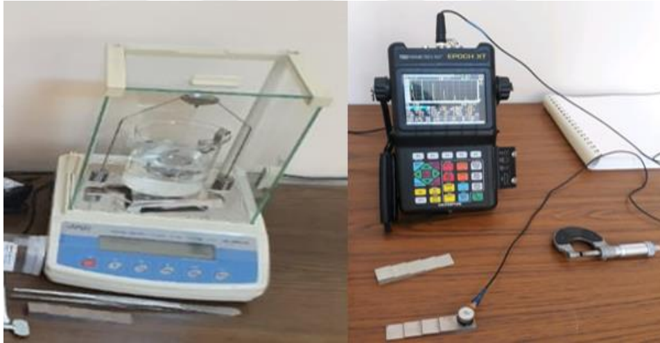
Şekil 3. 9. Yoğunluk ölçümünde kullanılan Arşimet yoğunluk kitli hassas terazi, OLYMPUS EPOCH XT cihazı ve mikrometre
