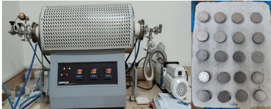
Şekil 3. 6. Sinterleme işlemi için kullanılan atmosfer kontrollü tüp fırın ve alümina üzerine yerleştirilmiş numuneler
