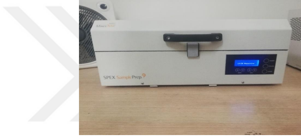
Şekil 3. 2. Mekanik alaşımlama işlemi yapılan SPEX™ 8000 cihazı
