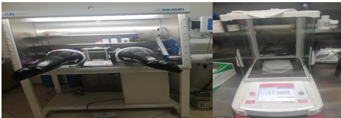
Şekil 3. 1. MBraun™ Labstar eldivenli kutu (glove box) ve hassas terazi
