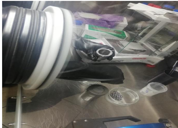
Şekil 3. 3. Mekanik alaşımlama işlemi için kullanılan vial ve bilyalar
