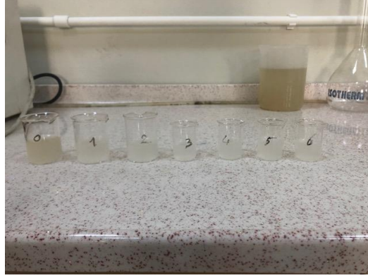
Şekil 4.13. O 3 /H 2 O 2 prosesinin numune bulanıklığına etkisi
