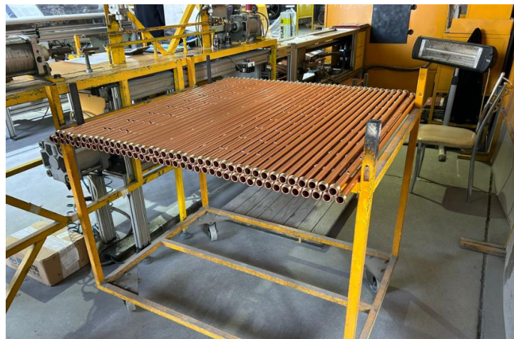
Şekil 3.5. Hazırlanan toplayıcı boruların resmi.
