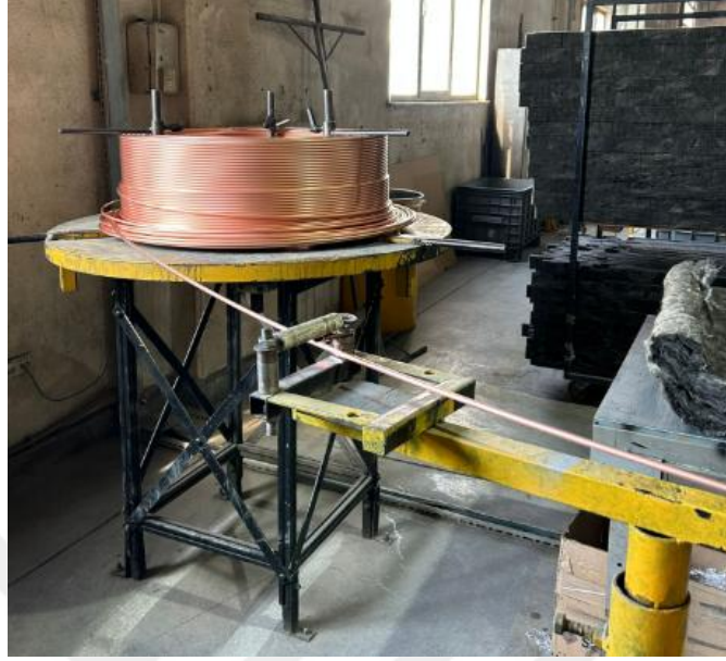
Şekil 3.4. Bakır boru kesimi.
