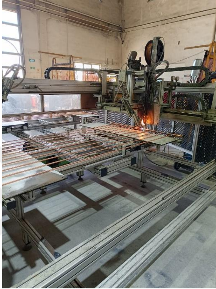
Şekil 3.6. Boruların birleştirilmesi işlemi.
