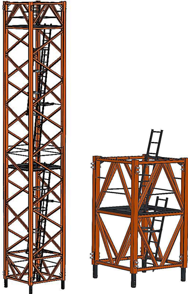
Şekil 3.9. Kule vinç mastı
