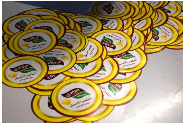
Görsel 37: Bobs kesim ile kesilip ayrıştırılmış etiketler.
