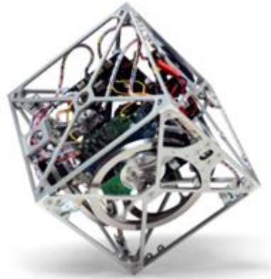
Şekil 5. Bir Cubli Modelinin Üç Adet Reaksiyon Tekerini ile Üç Eksende Kontrolü (Muehlebach ve D'Andrea, 2017)
