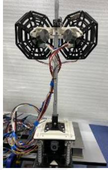
Şekil 2. Bir Ters Sarkaç Modelinin Çift Reaksiyon Tekerini ile Çift Eksende Kontrolü (Baimukashev vd., 2020)
