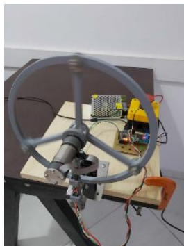
Şekil 1. Bir Ters Sarkaç Modelinin Tek Reaksiyon Tekerini ile Kontrolü (Chinelato vd., 2020b)
