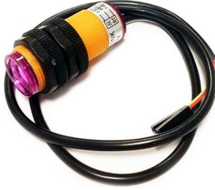
Şekil 3.6. MZ80 Kızılötesi Sensör (80cm Menzilli Kızılötesi Sensor, 2022)
