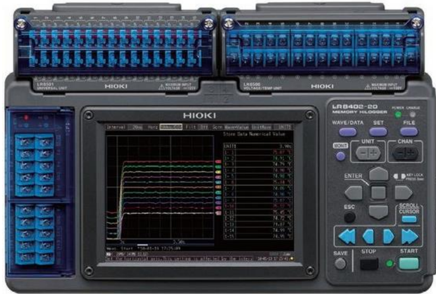
Şekil 3.29. Deneylerde veri toplayıcısı olarak kullanılan Data Logger
