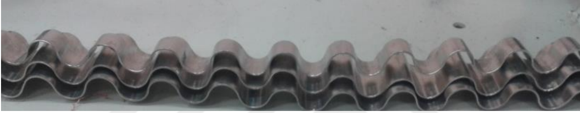
Şekil 3.35. n_1=D/4 genlikli sinüsoidal ondüle şerit elemanlar
