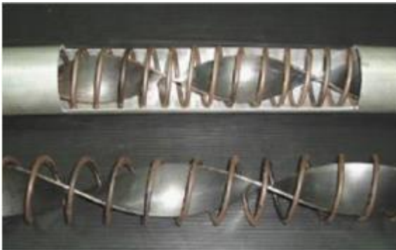
Şekil 3.12. Telle sarılmış helisel kesitli iç eleman
