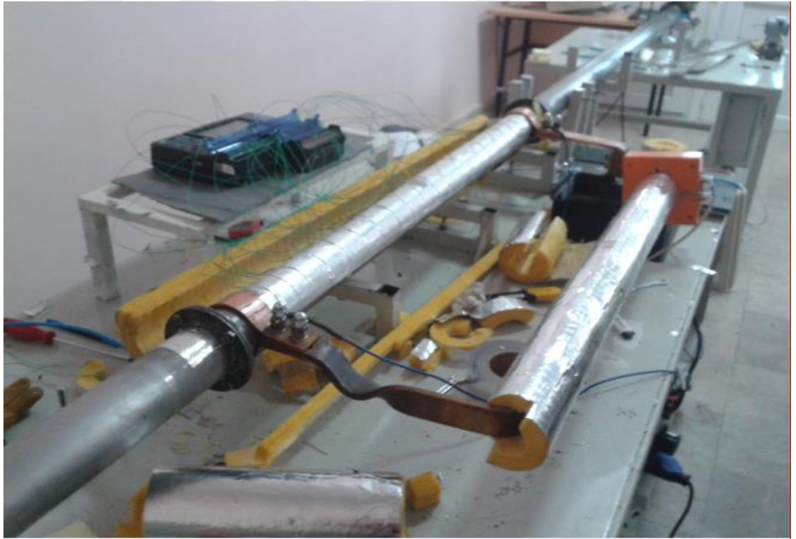
Şekil Ek-4.4. Dairesel kanal içerisindeki sinüsoidal ondüle şerit elemanın konumlandırılması
