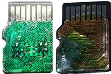
Şekil 4.14. Lehim maskesi uygulanmış hafıza kartı
