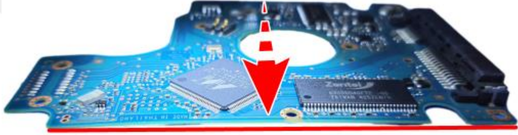
Şekil 3.106. PCB eğilmesi sonucunda içerisinde iç yol kopukluğu
