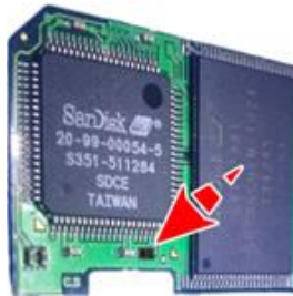
Şekil 3.136. Hafıza kartı üzerindeki devre elemanlarının bozulması
