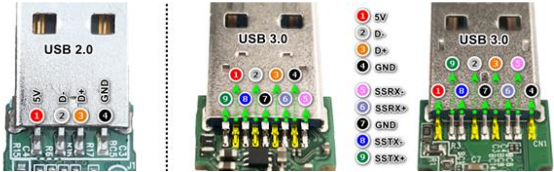
Şekil 3.41. USB flash bellek soketlerinin pin bağlantıları (Blizzard, 2018)
