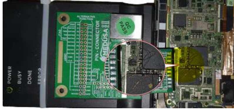
Şekil 3.119. ISP bağlantısı yapılmış bir cihaz örneği
