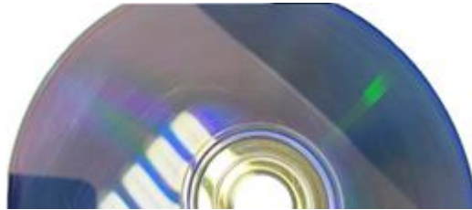
Şekil 3.85. Optik medyada hafif çiziklerin olması
