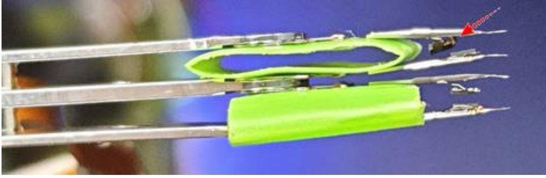
Şekil 3.108 Okuma/ yazma kafalarının bozulması
