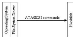
Şekil 3.19. Hard disk çalışma prensibi (Breeuwsma ve ark., 2007)
