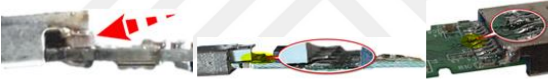
Şekil 3.129. USB soket pinlerinin temas etmemesi
