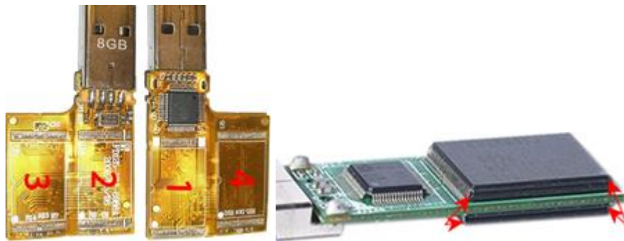
Şekil 3.40. Dört adet veri çipine sahip USB flash bellek örnekleri (Dec, 2012)
