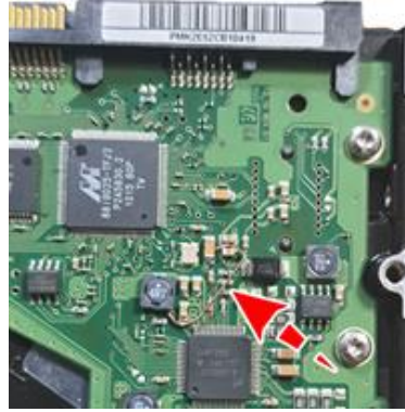
Şekil 3.115. PCB’de elektrik akımını engelleyecek materyallerin bulunması
