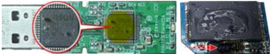
Şekil 3.151. Denetleyicisi zarar görmüş USB flash bellek ve hafıza kartı
