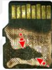
Şekil 3.156. Hafıza kartı yüzeyinin fazla kazınması
