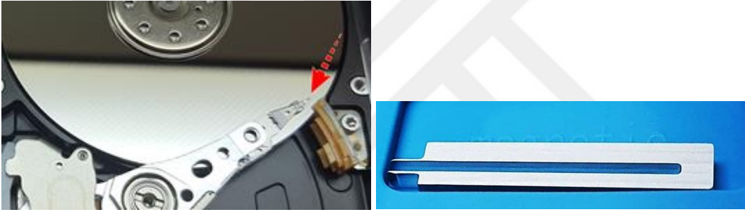
Şekil 3.109 Okuma/ yazma kafalarının yapışması ve kafa ayırıcı
