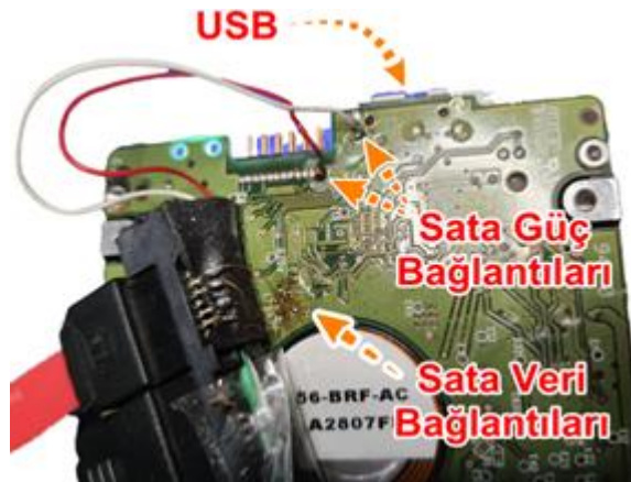
Şekil 3.114. USB soketi bozuk diske sata veri yolu yapılmış örneği
