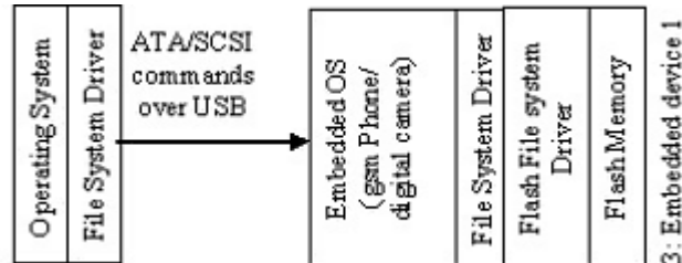
Şekil 3.65. Gömülü cihazların çalışma prensibi (Breeuwsma ve ark., 2007)
