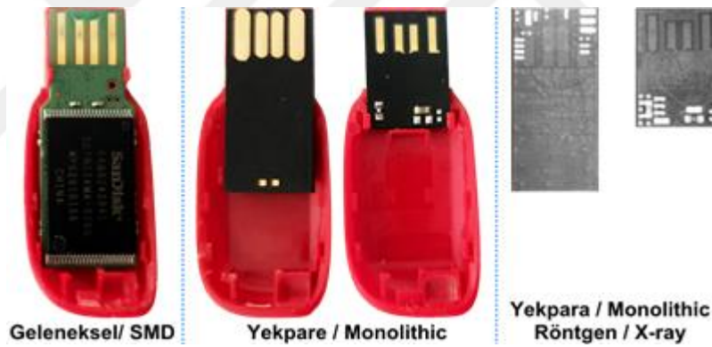
Şekil 3.48. Bellek türlerine göre USB flash bellekler ve x-ray altındaki görüntüleri
