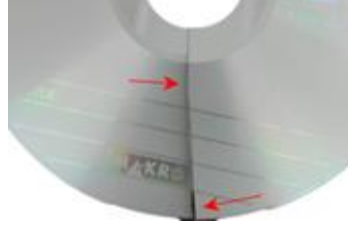
Şekil 3.83. Optik diskte çatlak olması
