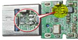
Şekil 3.131. Devre elemanının parçalanması/ kaybolması
