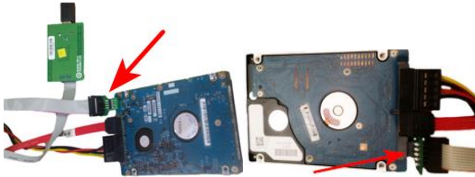
Şekil 3.162. Terminal bağlantısı yapılmış Fujitsu ve Seagate marka diskler
