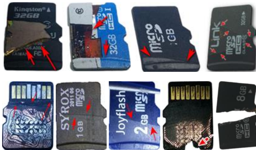
Şekil 3.154. Kırık, çatlak ve ezik hafıza kartı örnekleri
