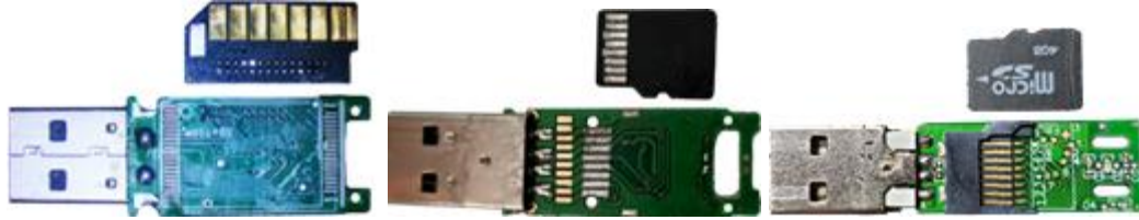
Şekil 3.47. Hafıza birimi olarak hafıza kartı kullanılan USB flash bellekler
