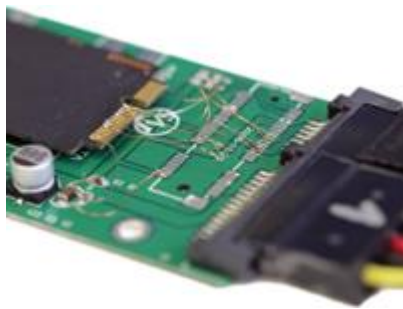
Şekil 3.142. M.2 SSD'ye sıvı teması sonrası veri yollarının çalışmaması (ITHOPE s.r.o., 2021)
