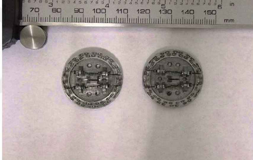
Şekil 5.15. Talaşlı imalat yöntemi ile üretilmiş katlanabilir anvil
