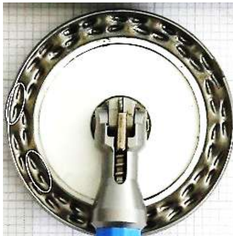
Şekil 4.3. 28mm çapta anvil üzerindeki zımba yuvası sayısı, 26 adet. (DST Series EEA28)
