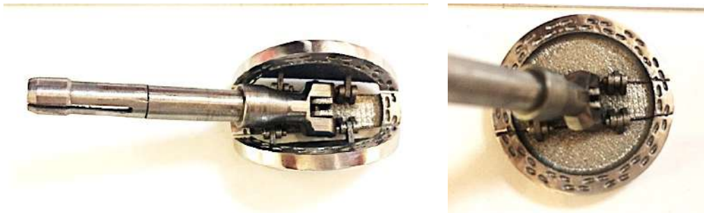
Şekil 5.14. SLS 3B baskı yöntemiyle üretilmiş gerçekçi prototip
