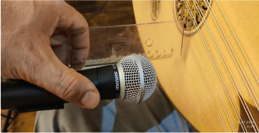
Şekil 62-P-3 için uygulanan 10 cm mikrofon plasmanı
