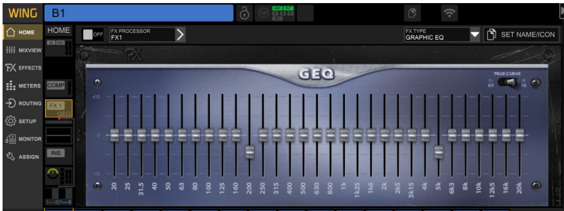
Şekil 47-Feedback önlemek için yapılan grafik ekolayzır
