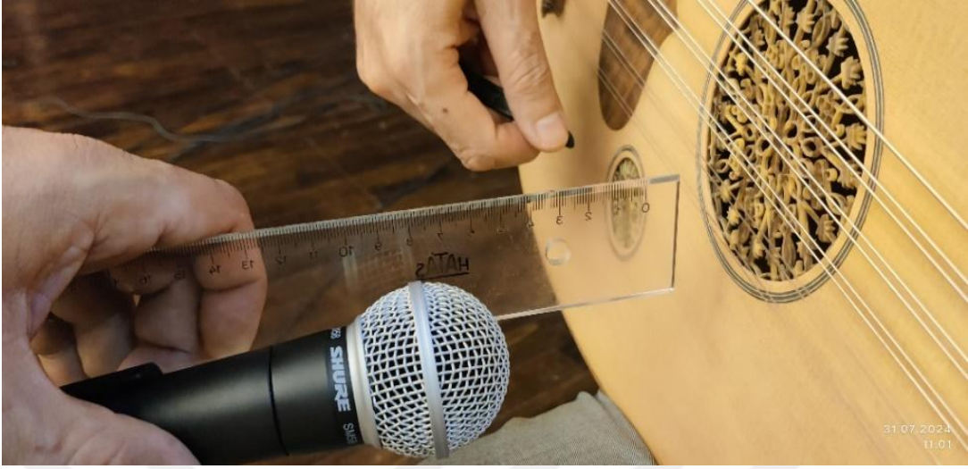
Şekil 57-P-2 için uygulanan mikrofon plasmanı 10 cm
