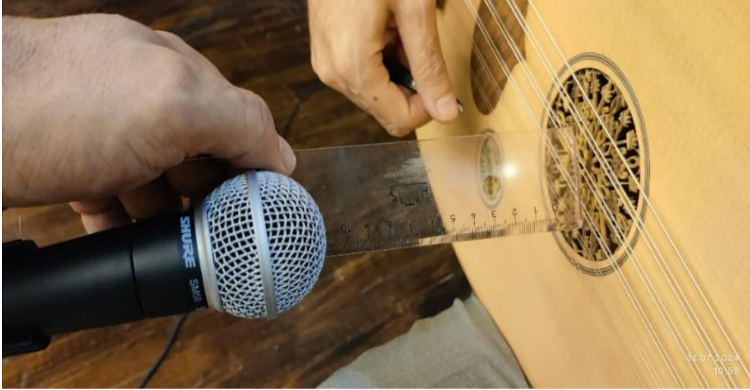
Őekil 48-P-1 iin uygulanan mikrofon plasmanı 10 cm mesafe
