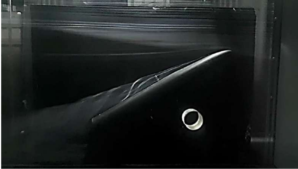
Şekil 3.16 Yarı-eliptik model üzerinde duman tel akış görüntülemesi ( \alpha=20^\circ , Re=64000 )
