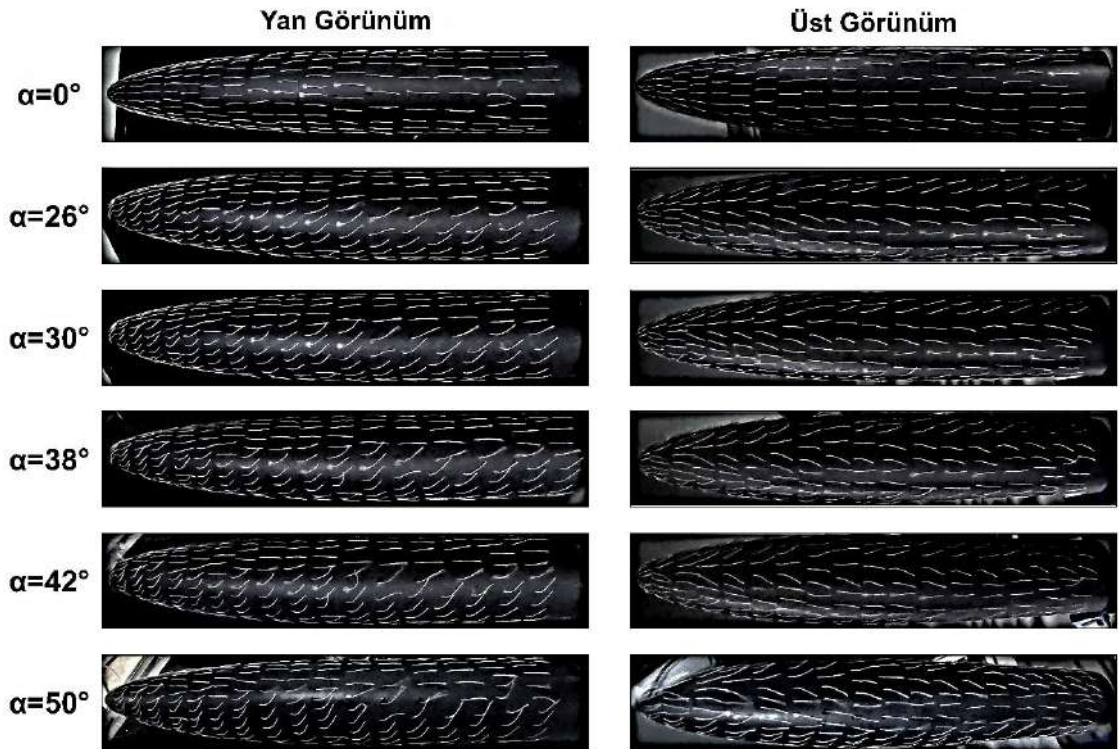
Şekil 4.67 D=60 mm, L=330 mm eliptik burun yapılı, küt kuyruklu model üzerinde Re=4.8 \times 10^5 değerinde, 0^\circ ve 26^\circ < \alpha < 50^\circ hücum açısı aralığında iplikçik akış görüntülemesi
