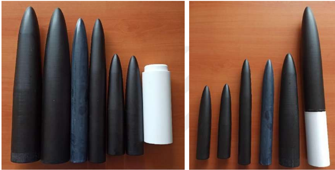
Şekil 3.13 Kuvvet ölçümü için yarı-eliptik ve eliptik uçlu modeller
