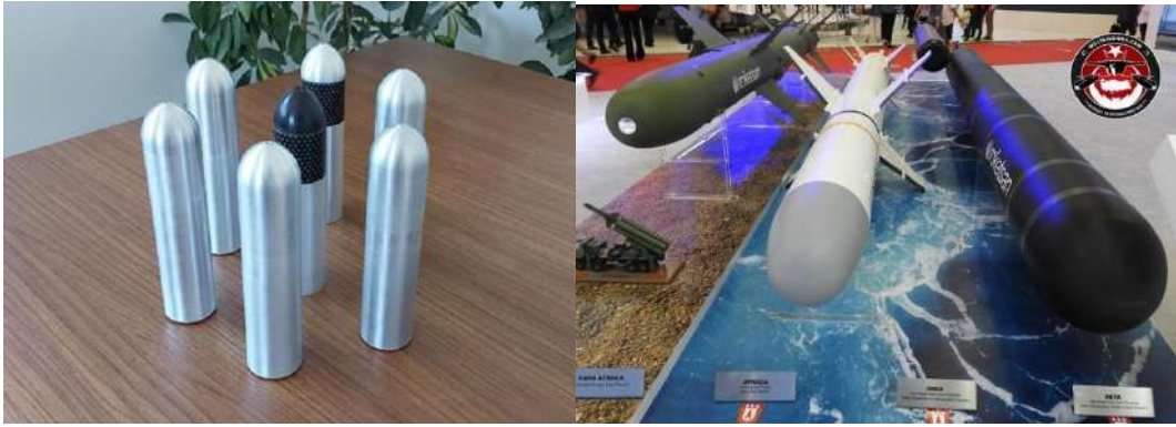
(a) Mini İHA Roketi (D=40mm, L=170mm)
