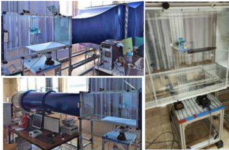
Şekil 3.11 Emmeli tip rüzgâr tüneli test bölgesi ve kuvvet ölçüm sistemi
