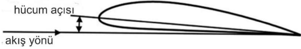
Şekil 3.5 Kanat yapısı (airfoil) üzerinde hücum açısı gösterimi (McLean, 2014)
