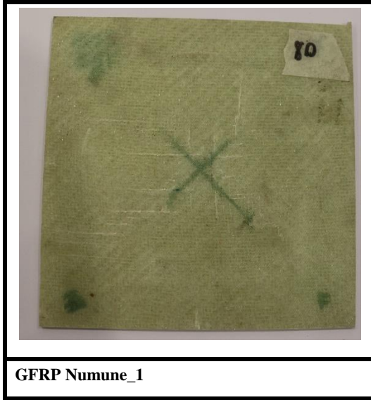
Şekil 7.17. Darbe testi cam elyaf-epoksi test numunesi deforme hali
