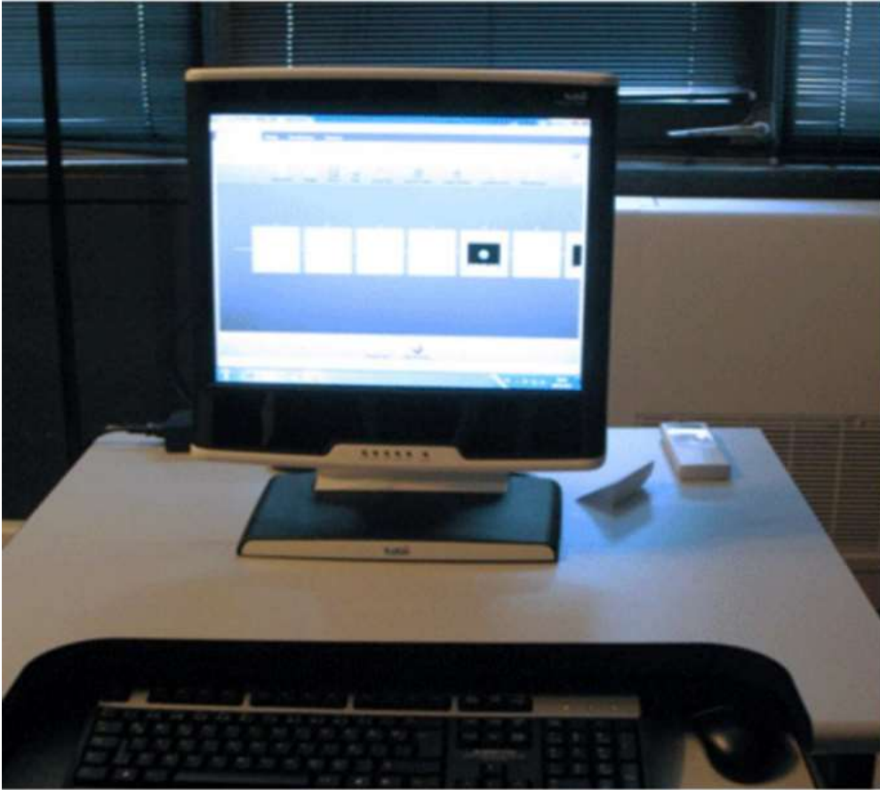
Şekil 3.12. Tobii T120 Göz Takip Cihazı
