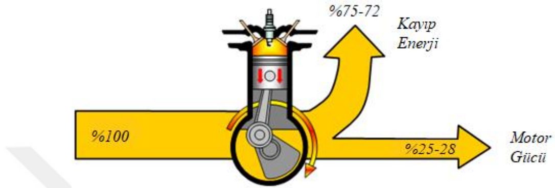
Şekil 3.10. Benzinli içten yanmalı bir motorda enerji denge diyagramı (Anonymous 2018)
