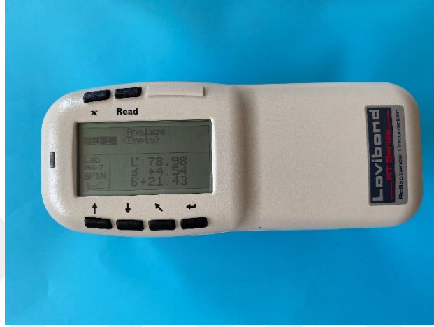
Şekil 3.9. Çalışmada kullanılan renk ölçüm cihazı (Lovibond RT Series, The Tintometer® Group, Lovibond House, UK)
