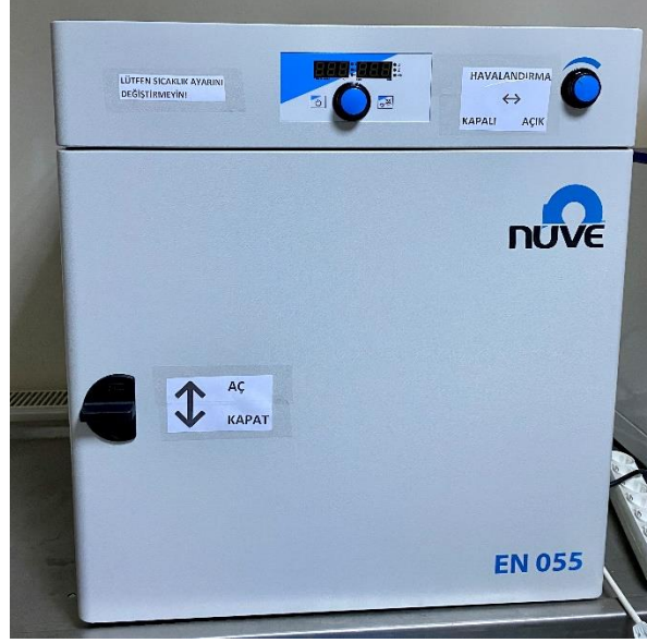
Şekil 3.7. Çalışmada kullanılan etüv cihazı (Nüve Incubator, EN 055, Ankara, Turkey)
