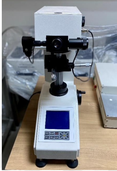
Şekil 3.11. Çalışmada kullanılan sertlik ölçüm cihazı (LHV 1-D, Bursam NDT, Bursa, Turkey)
