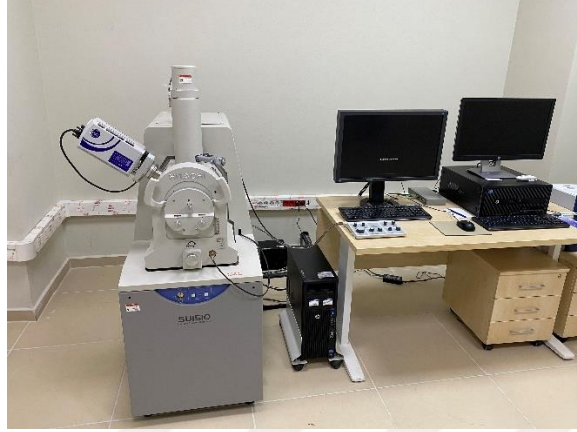
Şekil 3.15. Taramalı Elektron Mikroskobu (SEM) (Hitachi – SU 1510, Hitachi High-Technologies Corp, Tokyo, Japan)
