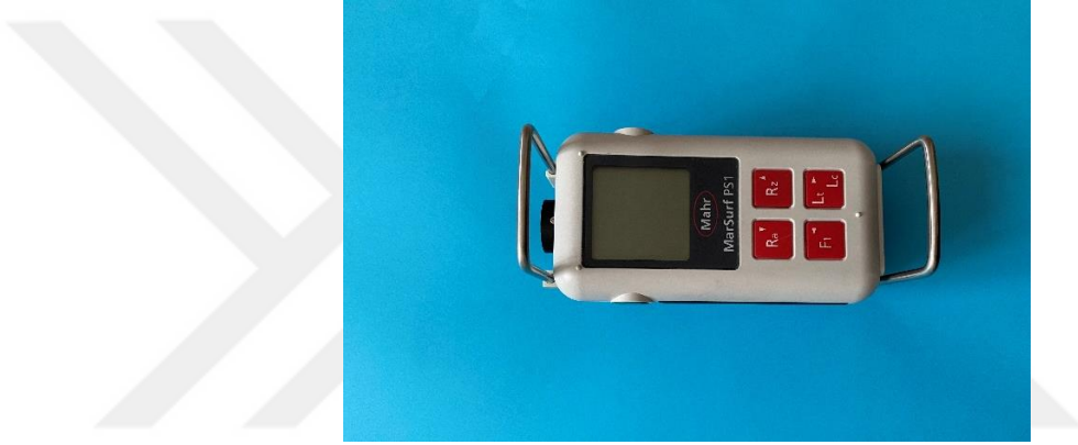
Şekil 3.10. Çalışmada kullanılan pürüzlülük cihazı (MarSurf PS1, Mahr, Göttingen, Germany)
