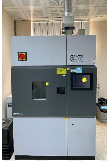
Şekil 3.13. Hızlandırılmış yaşlandırma cihazı (Ci4000 Weather-Ometer, Atlas Material Testing Technology, ABD)
