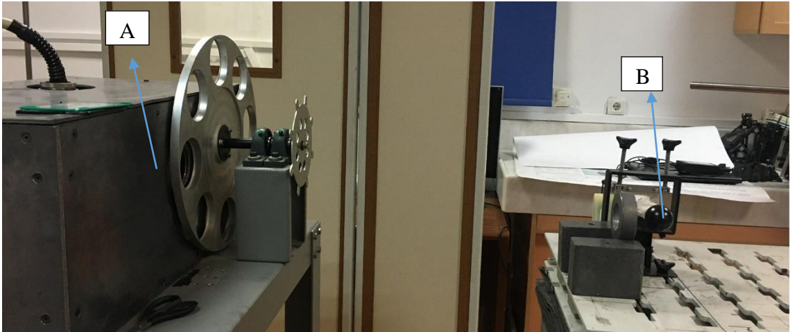
Şekil 4.4. Detektör ve X ışını tüpünün konumu a) X ışını tüpü, b) X ışını dedektörü
