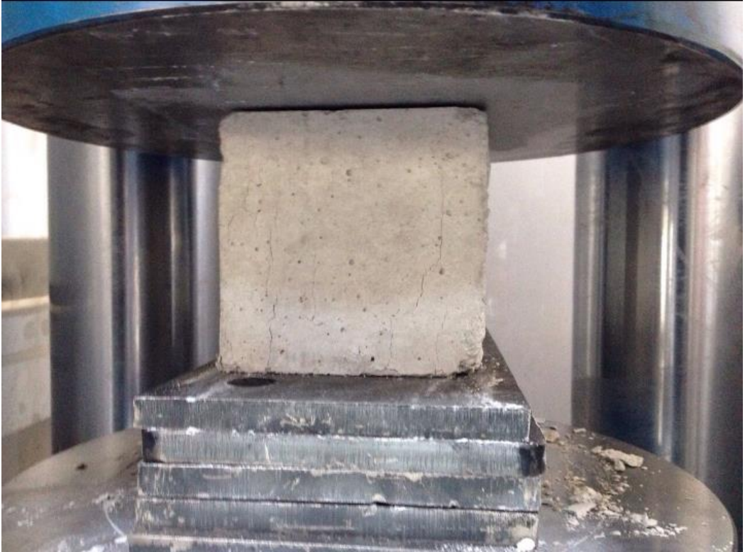
Resim 4.1.1.4. Laboratuvarda yapılan basınç deneyine tabii tutulan küp numune
