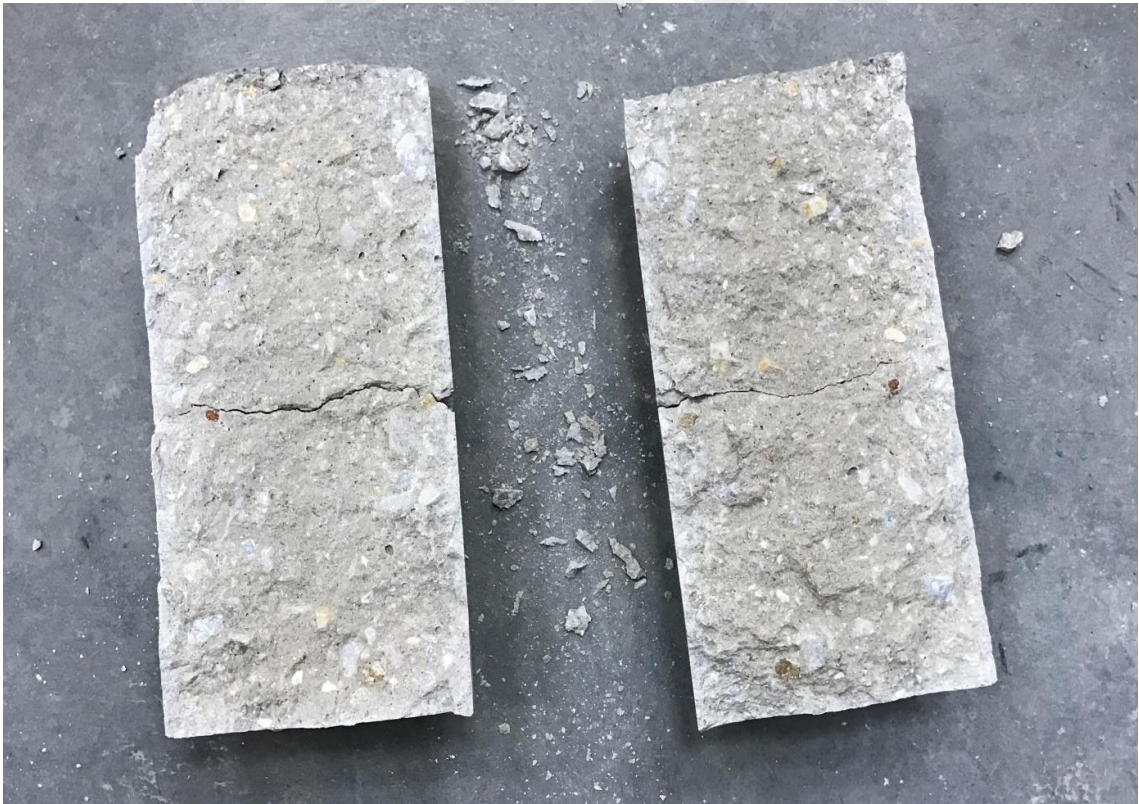
Resim 4.1.2.2.1. Yarma deneyine tabii tutulmuş hazır beton numunesi
