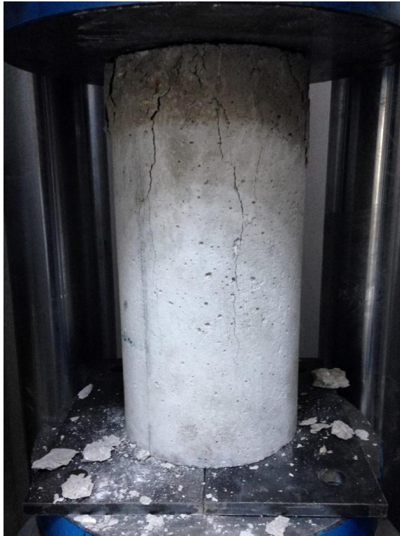
Resim 4.1.1.6. Laboratuvarında yapılan basınç deneyine tabii tutulan silindir numune
