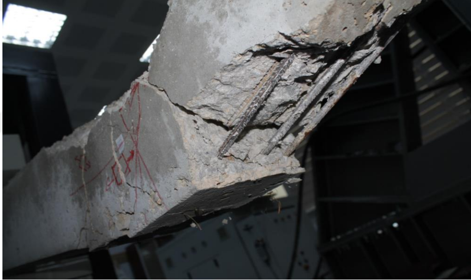
Resim 4.4.2.7. K3Ç kirişine ait deney sonrası fotoğrafı
