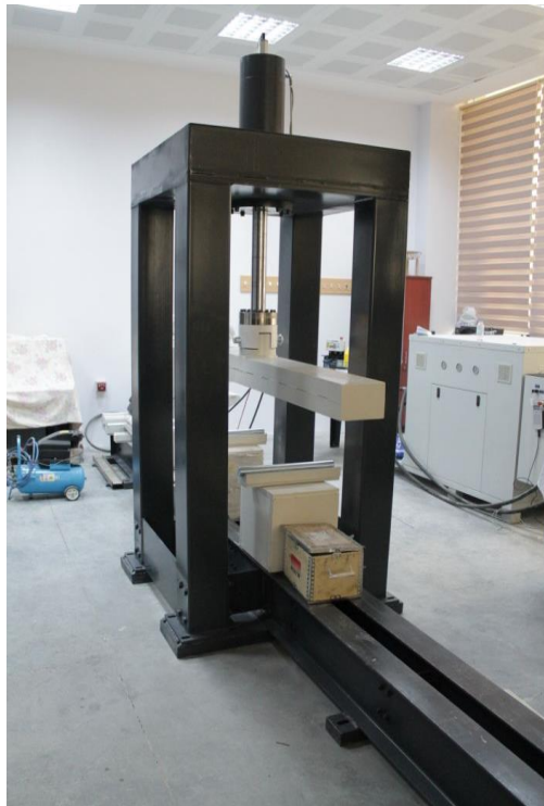
Resim 3.3.2.1. Üç ve dört nokta deneylerinin yapılacağı yükleme çerçevesi
