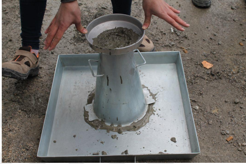
Resim 3.3.1.1 Betonun koniye doldurulması
