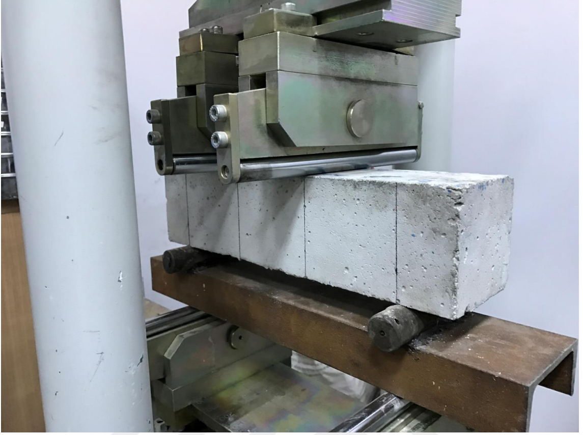
Resim 4.1.2.1.1. Laboratuvarda yapılan 4 nokta eğilme deney düzeneği
