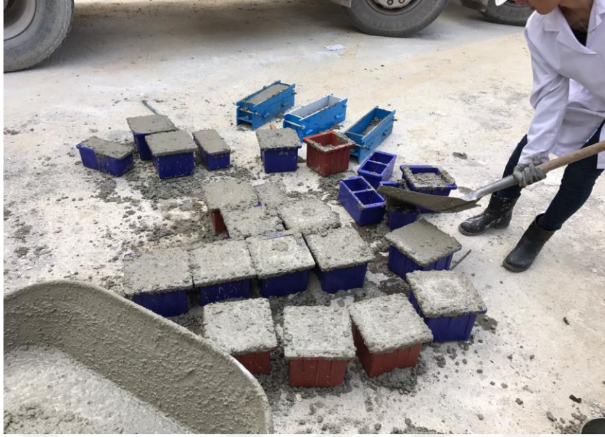
Resim 3.3.10. Betondan numune alınması
