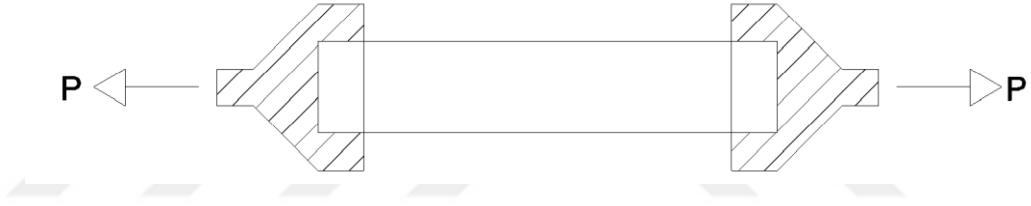
Şekil 4.1.2.1. Elema doğrudan çekme etkisi uygulayan deney düzeneği
