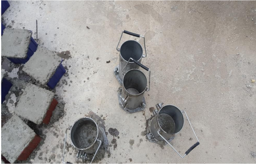
Resim 3.3.9. Betonun kademeli olarak doldurulması
