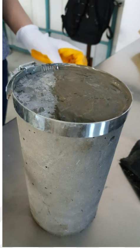
Resim 4.1.1.2. Pürüzlü yüzeye başlık yapılması
