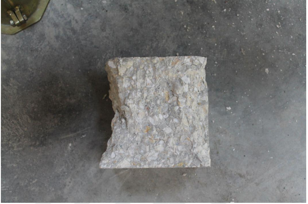
Resim 4.1.1.5. Laboratuvarında yapılan basınç deneyinde düzgün kırıldığı gözlenen küp numune
