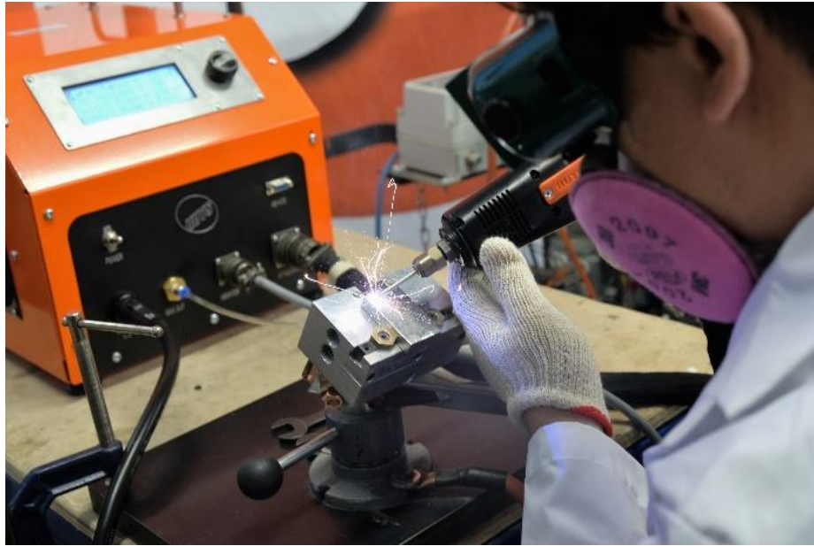
Şekil 2.1.Elektro kıvılcım makinası ve kaplama işlemi
