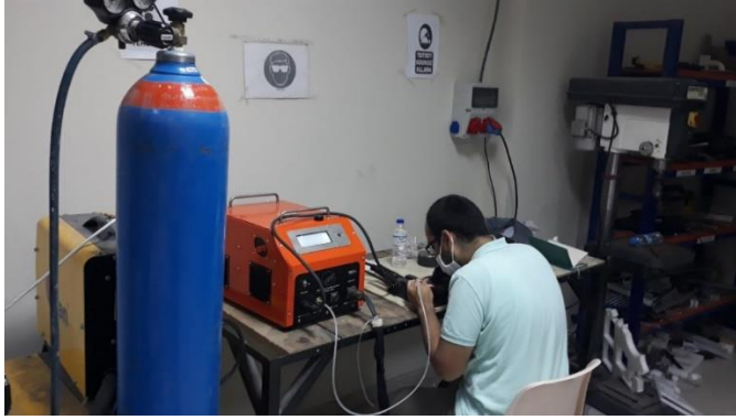
Şekil 3.40. Argon gazlı ortamda manuel EKB deneyleri
