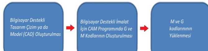
Şekil 3.2. Üç eksenli kaplama sistemde kaplama işlem adımları
