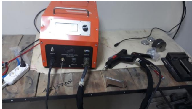
Şekil 3.39. EKB makinası ve kaplama tabancası
