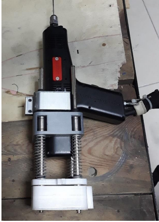
Şekil 3.36. Z eksenine kaplamaya yardımcı yaylı dengeleme sisteminin kaplama tabancasına montajı
