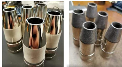
Şekil 2.10. MIG uçları kaplama uygulaması
