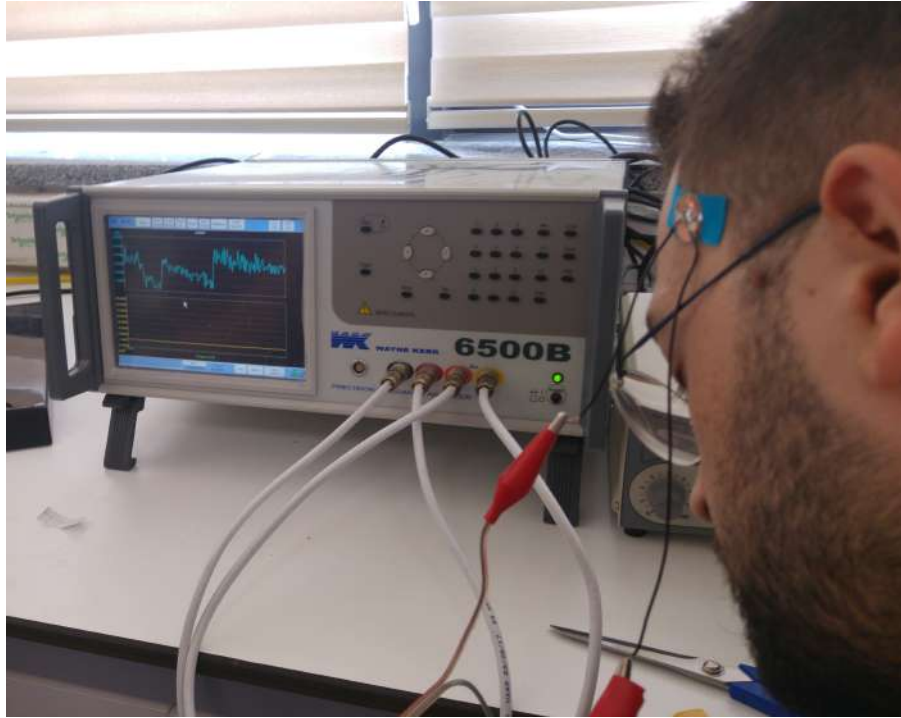
(c) Empedans analizörü ile şakaktan nabız ölçüm testleri
