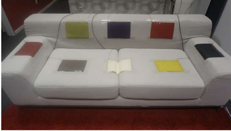
Şekil 1.18. İletken kumaşların kanepeye dikilmesiyle oluşturulmuş kapasitif postür sınıflama sistemi (Rus vd., 2017)
