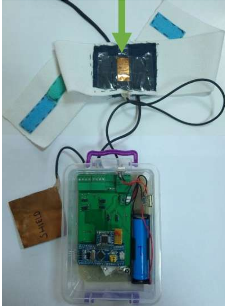
Şekil 3.22. Gırtlak hareketlerini ölçmek için oluşturulan sensör
