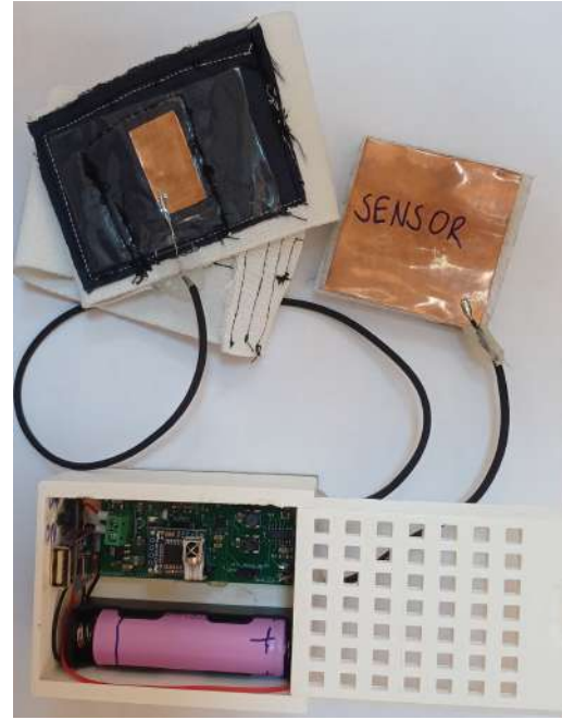
(a) Versiyon 2 ve 3 devre kartları boyut (b) Versiyon 3 devre kutusu ve sensör yapısı karşılaştırması
