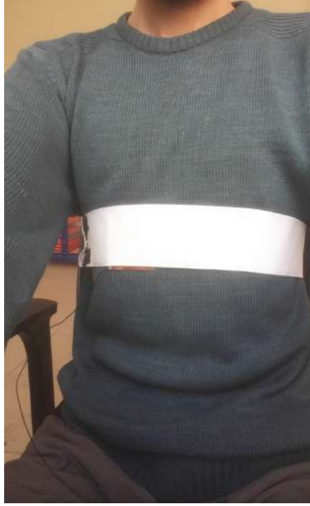
Şekil 3.1. Göğüsten kalp atımı ölçümü için sensör yerleşimi
