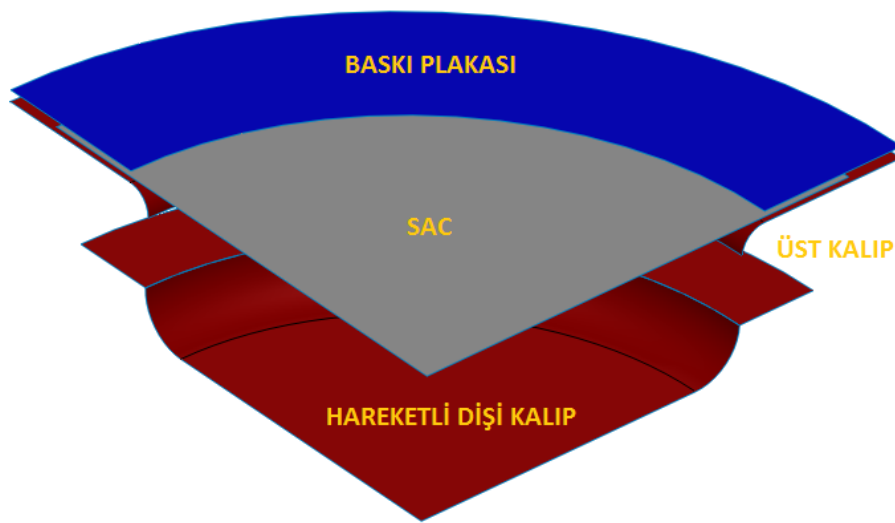
Şekil 3.24. Hareketli dişi kalıpla sac hidroşekillendirme prosesinin bileşenleri ve yüzey montajı
