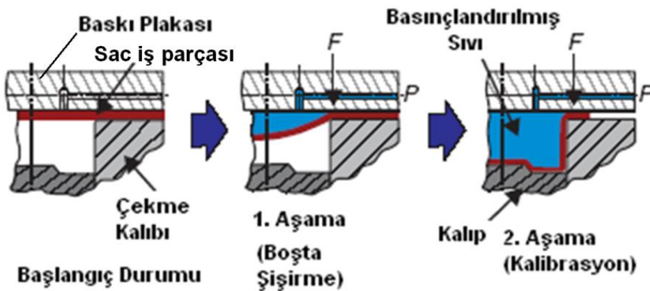
Şekil 1.3. Dişi kalıpla sac hidroşekillendirme yöntemi (Altan, 2006)
