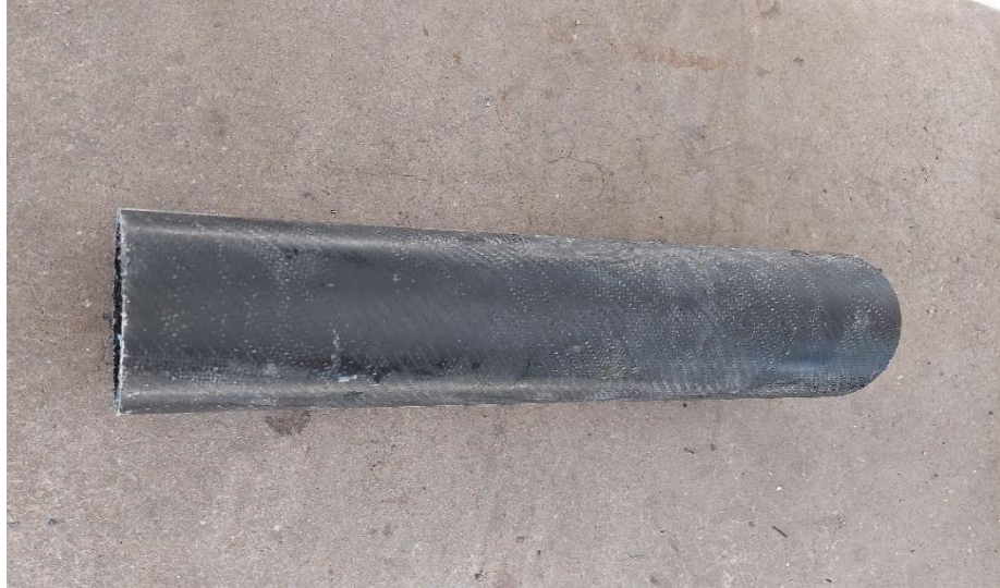
Şekil 3.7. TCKNT takviyesiz kompozit boru
