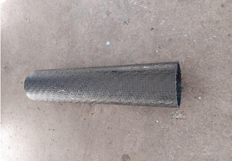
Şekil 3.6. TCKNT takviyeli kompozit boru
