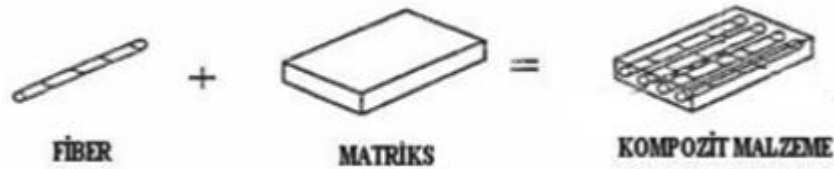
Şekil 1.1. Fiber ve matristen oluşan kompozit malzemenin basit şekli [3]
