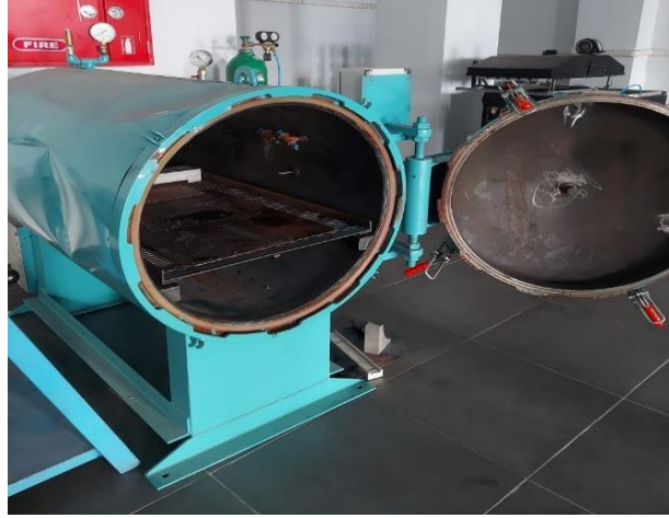
Şekil 1.18. Otoklavda torba kalıplama metodu
