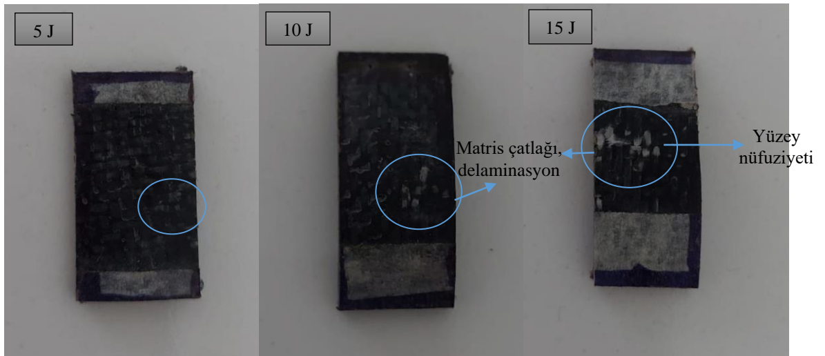
Şekil 4.13. TCKNT takviyesiz hasar analizi yapılan numuneler
