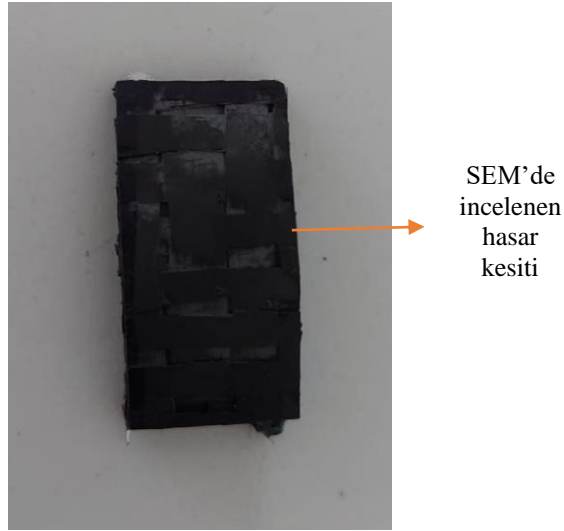
Şekil 3.10. 15x30 mm boyutundaki SEM analizine gönderilmiş numuneler
