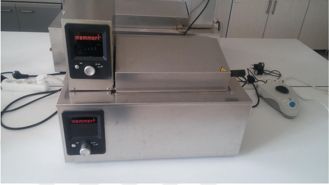
Şekil 3. 7. çŞeker analizinde kullanılan su banyosu ve vortex cihazı
