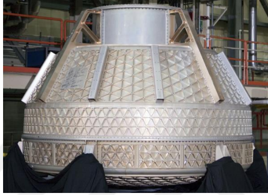
Şekil 31. Izgara Yüzey Uygulanmış Bir Uzay Aracının Dış Görünümü (Harris, 2019)
