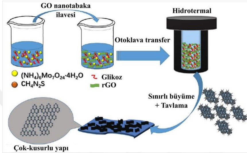
Şekil 1.9. Hidrotermal sentez ile \text{MoS}_2 büyütülmesine ilişkin şematik gösterim (Tian vd., 2019).
