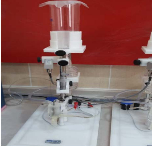
Şekil 3.3.b : İzole organ banyosu sisteminin haznelerinden biri
