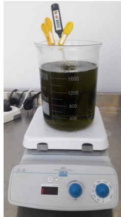
Şekil 3.28. Biyodizelin içinde kalan suyun ayrıştırılması
