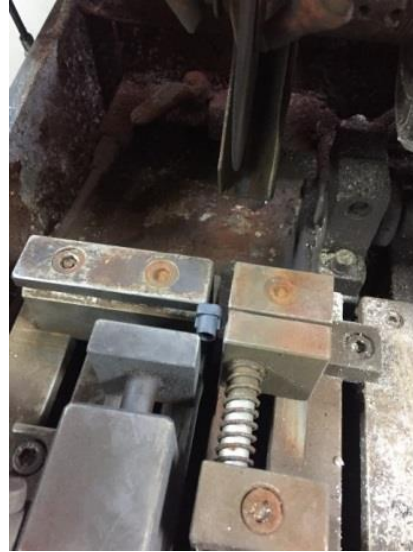
Şekil 4.13. Metacut kesme makinesinde numune kesimi
