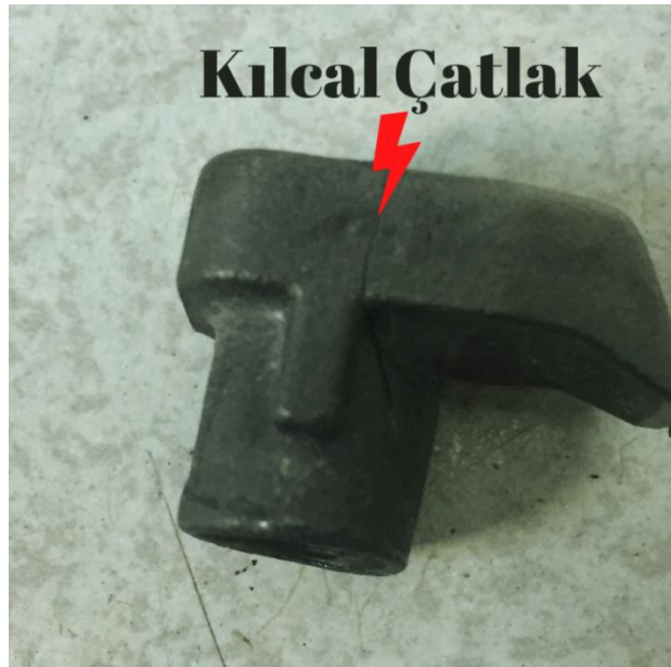
Şekil 5. 4. Baskı pabucunda kılcal çatlama
