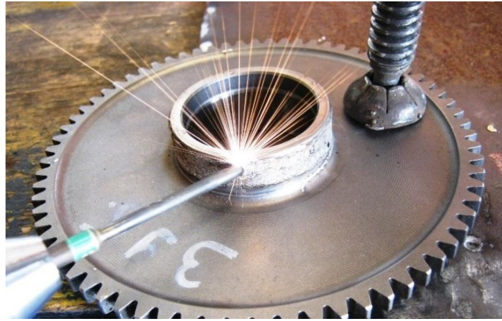
Şekil 2. 5. EKB kaplama prosesi ile dişli çark onarımı (weldtech.hu)
