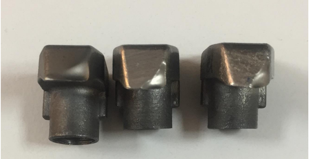
Şekil 5.9. Test sonrası aşınmış baskı pabuçları
