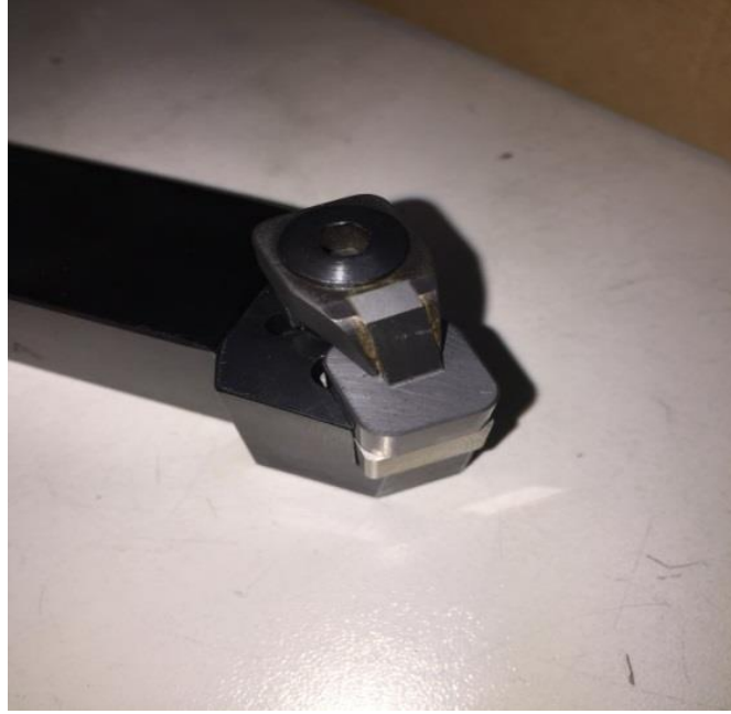
Şekil 3. 6. Sert metal kaynatılmış baskı pabucu
