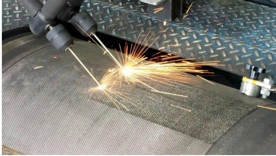
Şekil 2. 6. Tambur üzerine EKB prosesi ile kaplama (prweb.com)
