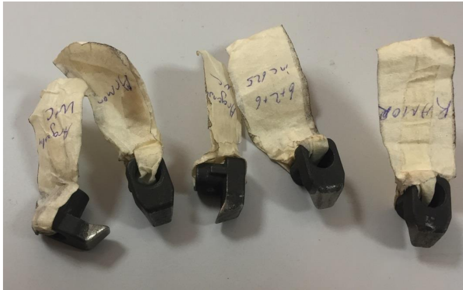
Şekil 5. 2. EKB yöntemi ile tungsten karbür kaplama yapılan baskı pabuçları
