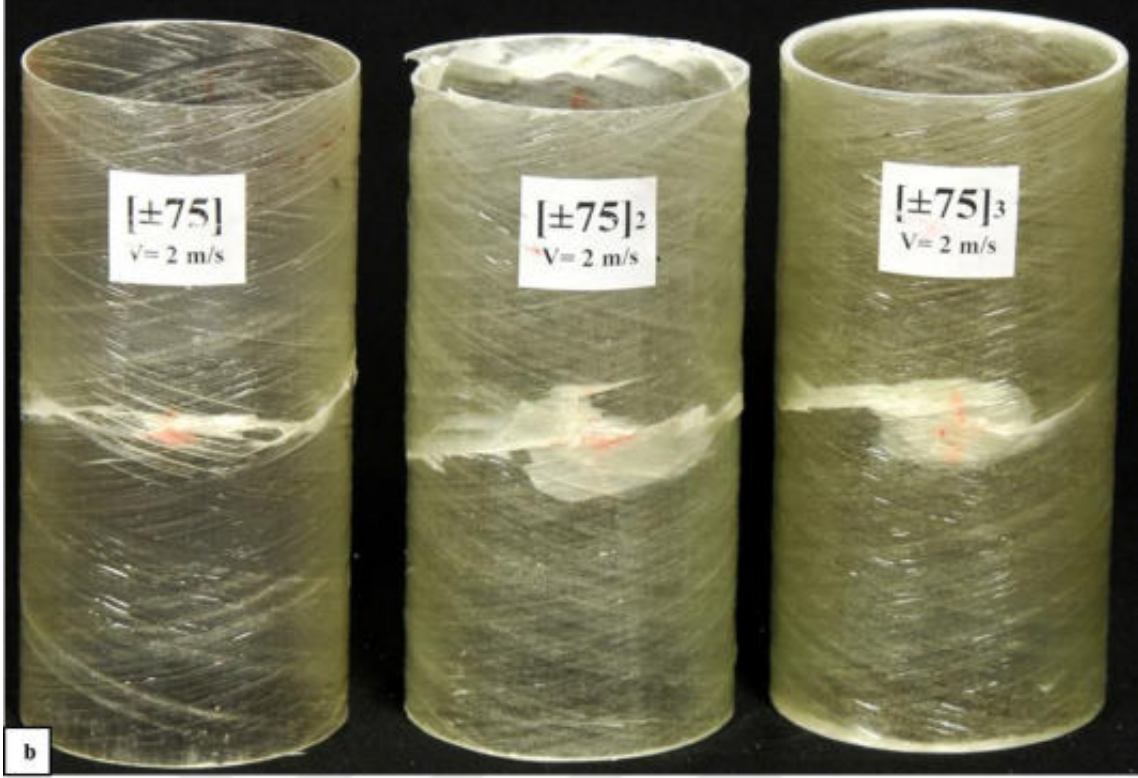
Şekil 4.70. 2, 4 ve 6 tabakalı ( 75^\circ ) elyaf sarım açısına sahip darbeli basma deneyi numuneleri a) deney öncesi ve b) deney sonrası
