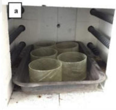
Şekil 3.4. Yakma deneyinin yapıldığı fırın
