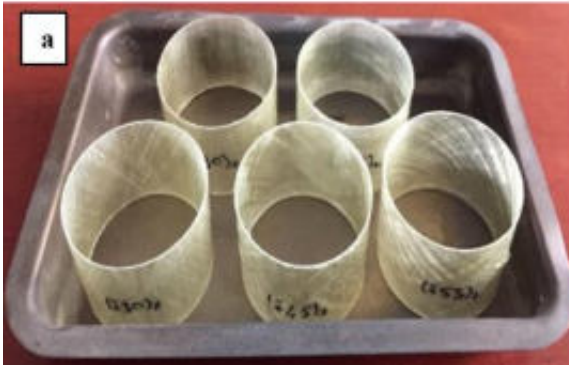
Şekil 3.5. Yakma testi (a) öncesi ve (b) sonrası numuneler
