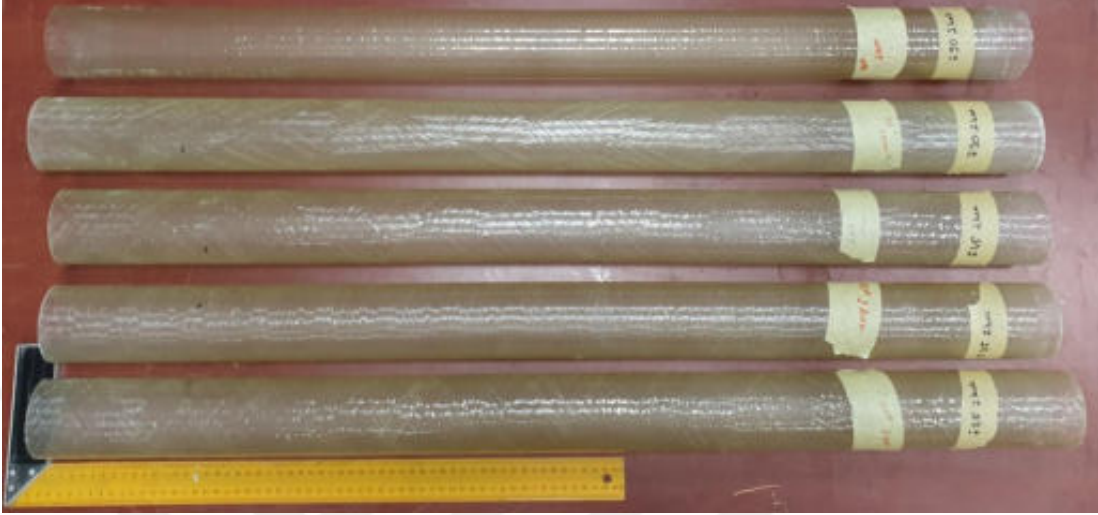
Şekil 3.1. Filaman sarım yöntemiyle üretilen 1 m’lik CTP borular
