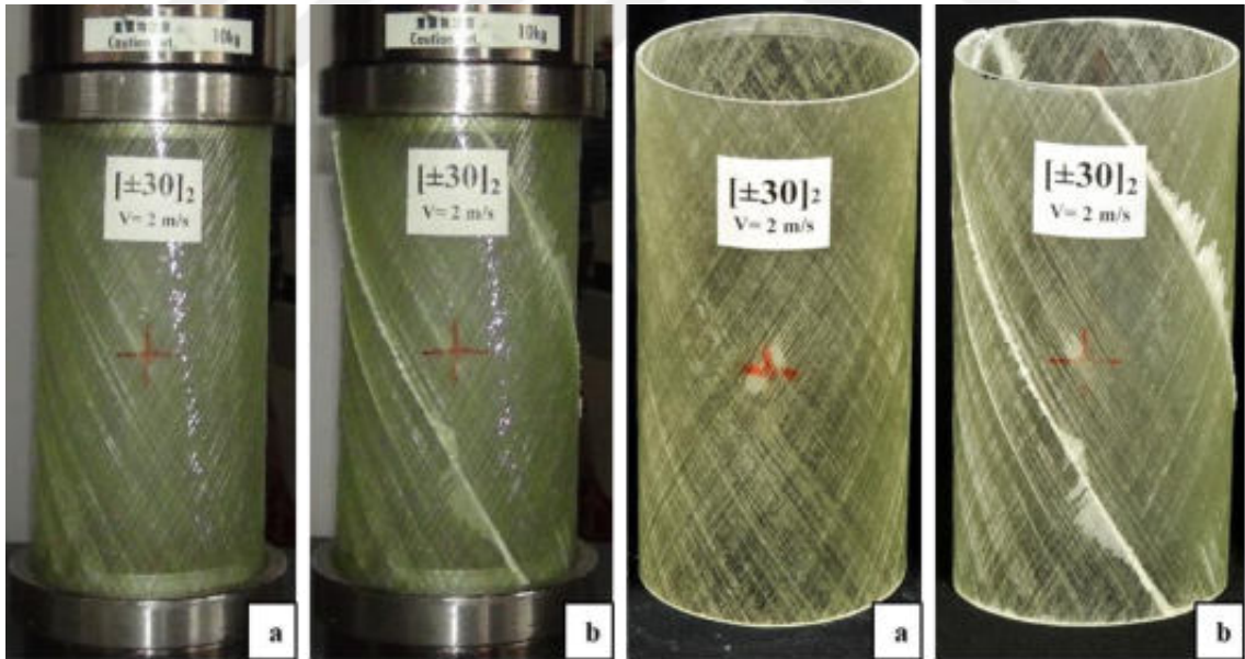
Şekil 4.51. 4 tabakalı (30°) elyaf sarım açısına sahip darbeli basma deneyi numuneleri a) deney öncesi ve b) deney sonrası
