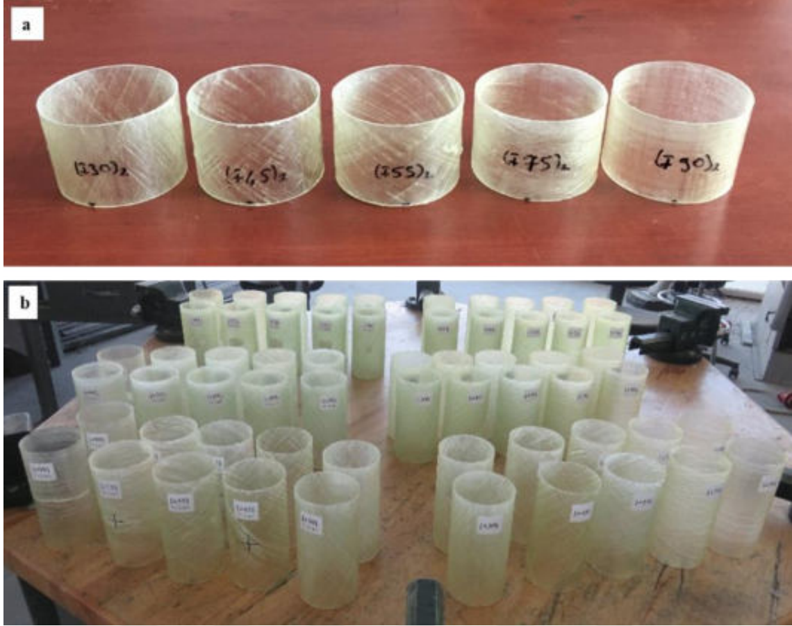
Şekil 3.3. Deneyler için hazırlanmış numuneler a) yakma deneyi numuneleri b) darbe ve basma deneyi numuneleri
