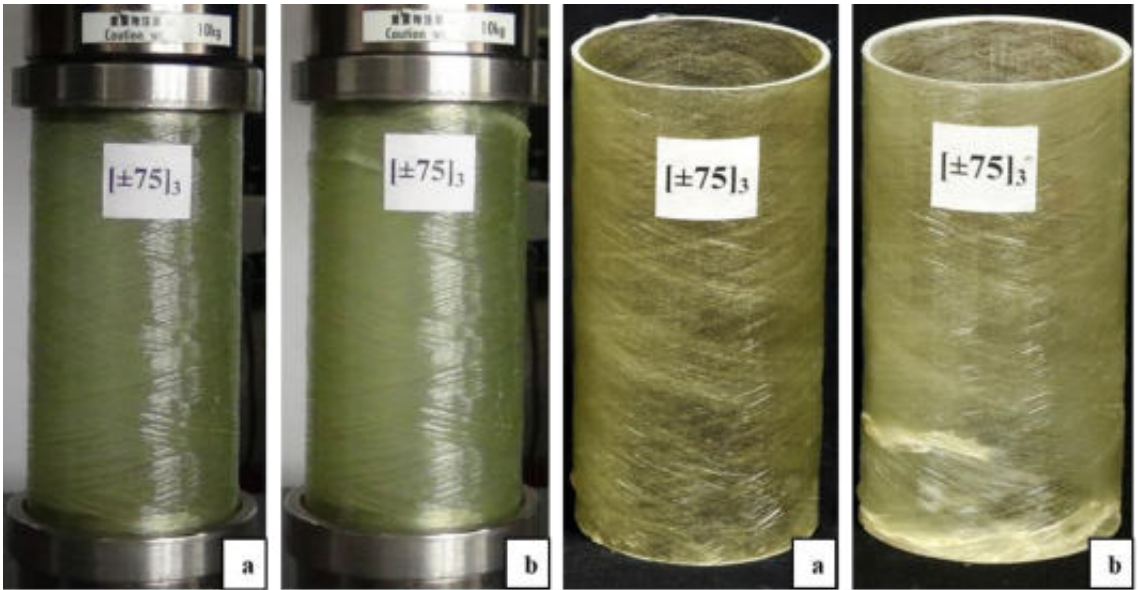
Şekil 4.30. 6 tabakalı ( 75^\circ ) elyaf sarım açısına sahip darbesiz basma numuneleri a) deney öncesi ve b) deney sonrası
