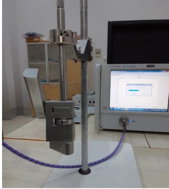
Şekil 3.8. Koaksiyel probun kalibrasyon işlemi
