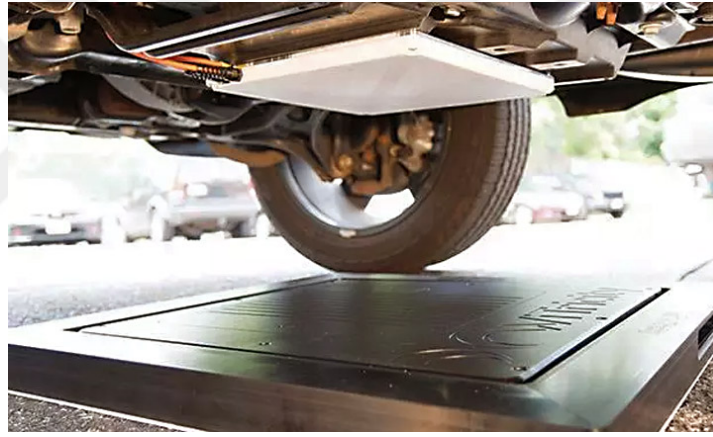
Şekil 1.8. Elektrikli bir aracın kablosuz şarj işleminin gerçekleşmesi gösterilmektedir.
