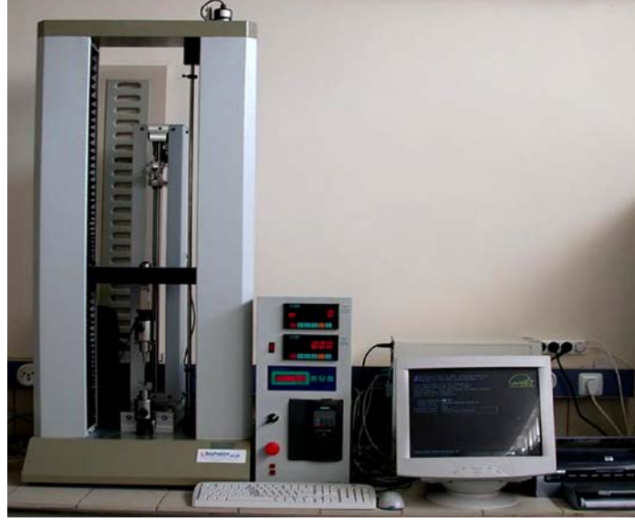
Resim 3,11: TEDEA Huntleigh Model No:615 çekme-basma test cihazı.
