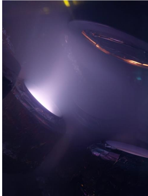
Şekil 3.5. Zn hedeften kopan atomların \text{O}_2 ile reaksiyonu sonucu alttaş üzerine büyütülmesi.
