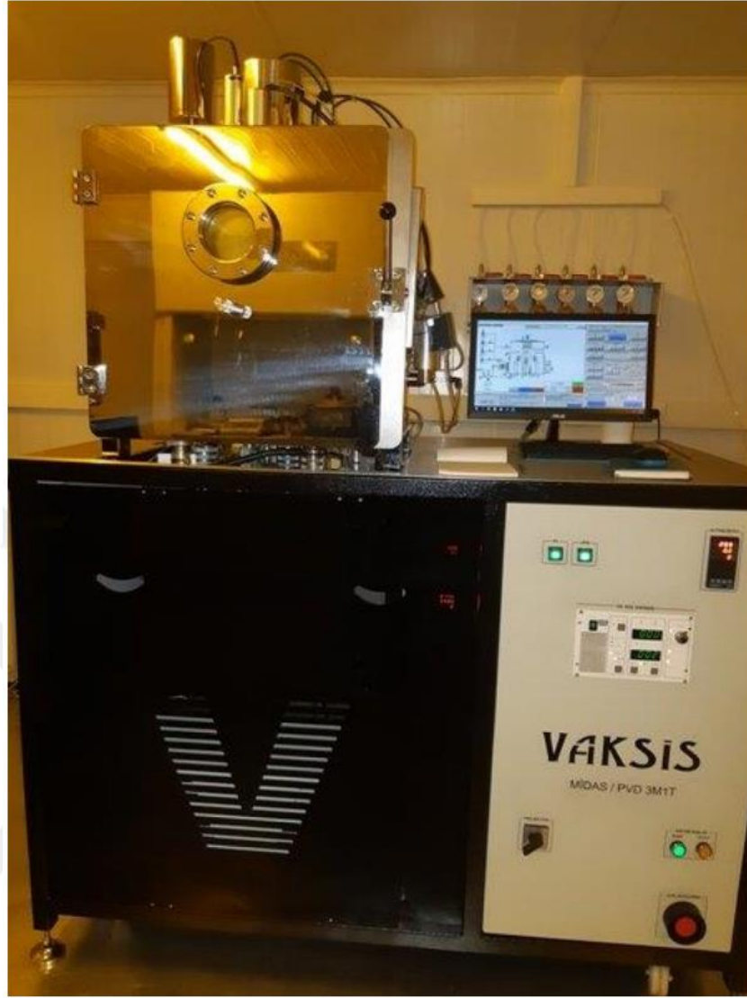
Şekil 3.6. ZnO ince film büyütmesinin gerçekleştiği tamamen bilgisayar kontrollü VAKSİS MİDAS/PVD 3M1T magnetik alan sıçratma sistemi.
