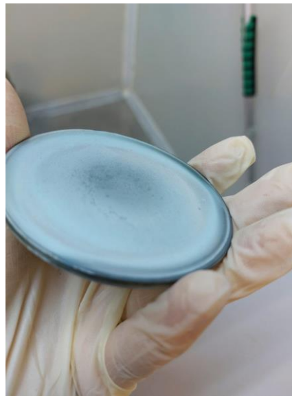
Şekil 3.3. %99.9 saflıkta, 3" çaplı ve 0.125" kalınlığa sahip Zn hedef malzeme
